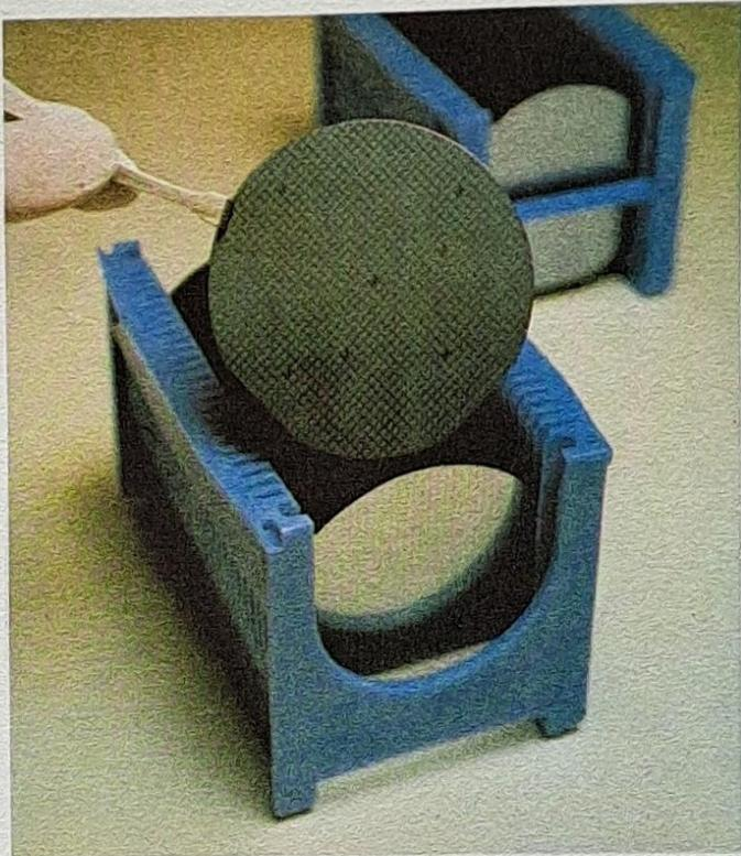
▲ O bloco cilíndrico de silício é cortado em discos, dando cada um umas 250 pastilhas. Depois de acabadas, são testadas antes de comercializadas.
