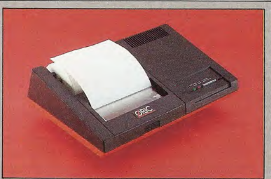
Impresora-plotter Constituye un excelente accesorio para el Atmos. Utiliza cuatro lápices de punta esférica para trazar líneas y texto en color. Puede dibujar textos de tamaño minúsculo hasta varias pulgadas de altura. Entre sus inconvenientes se incluyen la anchura del papel, de sólo 4 1/2 pulgadas, la reducida velocidad y el elevado precio de los lápices de punta esférica. La impresora-plotter no es adecuada para dibujar superficies sólidas de color
