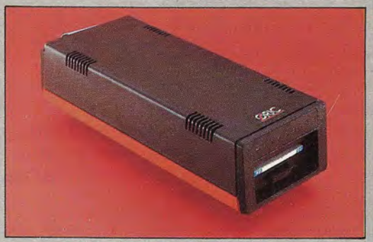
Unidad de disco La unidad de disco Oric utiliza discos de 3 pulgadas. Éstos vienen en una carcasa rígida de protección. La unidad posee una capacidad de 160 K en cada cara del disco. Se puede dar la vuelta a los discos y utilizarlos por la otra cara para dar un total de 320 K por disco. Las unidades Oric sólo pueden tratar archivos secuenciales
