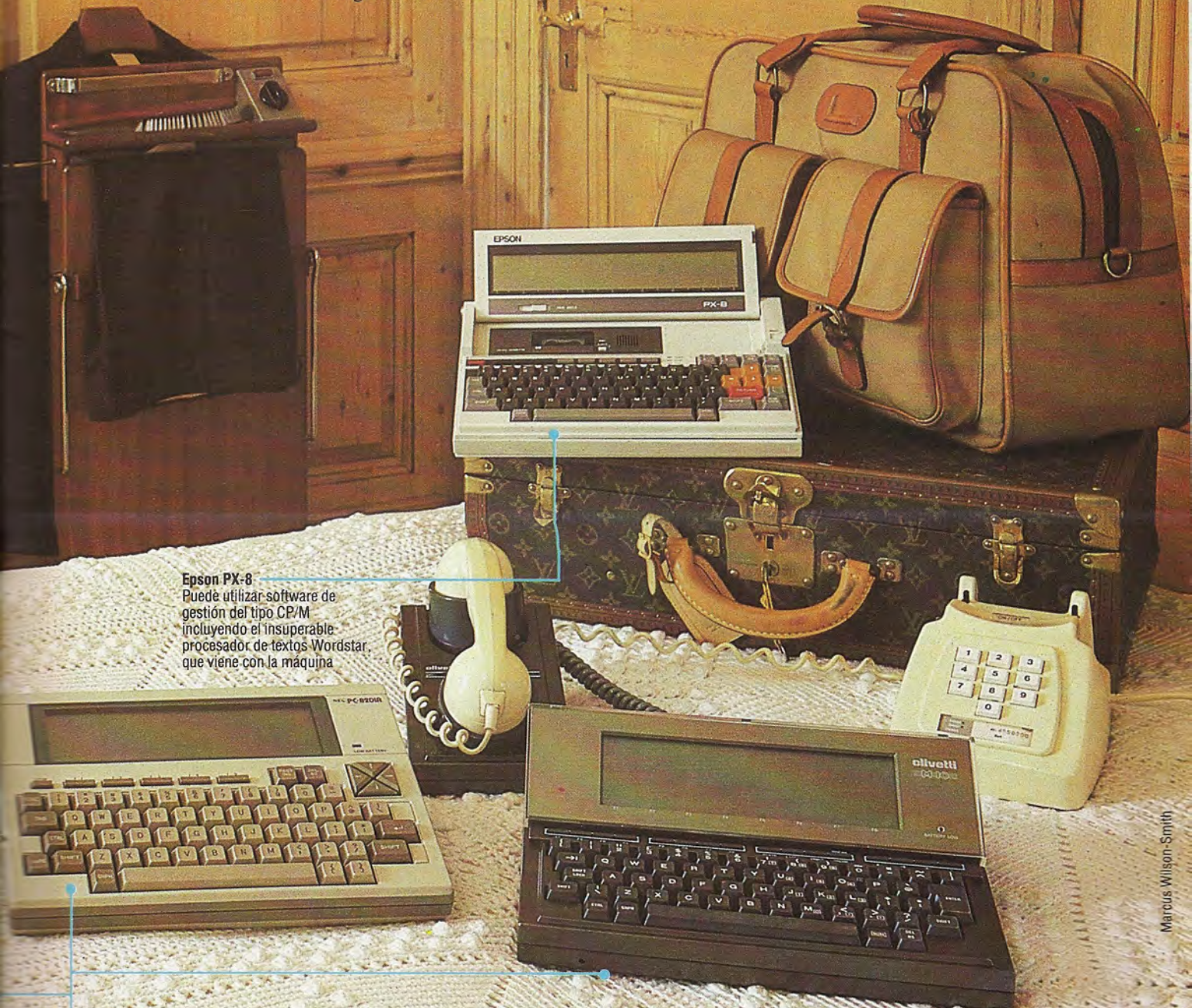
Tandy TRS-80 Modelo 100/NEC PC-8201A/Olivetti M10 Constituyen distintas versiones reempaquetadas del mismo micro. Comparten un excelente procesador de textos incorporado y una buena gama de interfaces. En la fotografía también vemos un modem a pilas de Olivetti
