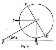
worden. Eine Kugel vom Halbmesser rsei um eine horizontale Achse KK drehbar und zwei Rollen A und B sollen sie in dem größten Kugelkreise berühren, der horizontal liegt. Sie sind durch einen Rahmen, den wir als den festen Rahmen bezeichnen wollen, so mit einander verbunden, daß ihre Ebenen senkrecht zu einander stehen und durch den Mittelpunkt O der Kugel gehen. Auf der horizontalen Achse der Rolle A soll ein Schieber P verschiebbar
