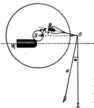
scheibenrad den Radius  $R_2$  haben möge, um  $R_2 d\psi = \frac{R_2}{R_1} dx_0$ . Ist der Radius dieses an der Scheibenachse sitzenden Zahnrädchens  $R_8$ , so ist seine Abwicklung  $R_3 d\varphi = R_2 d\psi$ , also der Winkel, um den sich die Scheibe dreht,
