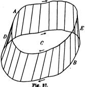
fahrenen Fläche zu bestimmen, ist außer der Kenntnis der Stablänge nur noch die Messung der Länge des Weges nötig, den ein Punkt des Stabes senkrecht zur Stabrichtung zurücklegt.
