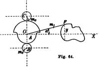
Rädern und dem Fahrstift ruht. Die beiden Räder laufen hintereinander in der Nut (Rinne) eines Lineals, so daß der ganze Wagen parallel mit dem Lineal geradlinig verschoben werden kann (Fig. 64). Dieser Wagen trägt ein horizontal liegendes Zahnrad A, das sich um einen senkrecht in seinem Mittelpunkte O stehenden Zapfen dreht.
