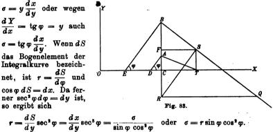
Man errichte in *B* senkrecht zur Tangente *BE* die Normale der Integralkurve, welche in *S* die Ordinate von *T* schneide. In *S* errichte man wiederum eine Senkrechte *SR* auf *SB*, deren Schnittpunkt mit der Ordinate *CB* in *R* sei. Eine Parallele *RQ* zur *x*-Achse trifft die Normale *BS* im Punkte *Q*, dem gesuchten Krümmungsmittelpunkt. In der Tat ist, wenn wir noch die Parallele  $FS = \sigma$  ziehen,
