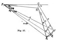
sich hervorgebracht und der Leitstrahl PF überstreicht einen Winkel  $d\gamma$ . Der ganze bei der Bewegung des Fahrstifts von F bis  $F_2$ vom Leitstrahl überstrichene Winkel ist dann  $d\varphi = d\psi + d\gamma$ .
