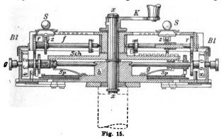
sitzt, bis zur äußersten mit nur einem Zahne (Fig. 16). Wenn ein Knopf an einem der Einstellschlitze des Deckels auf eine bestimmte Zahl der am Schlitz stehenden Skala eingestellt wird, so geht das 8\* Zahnrad bei der Drehung der Scheibe über die Reihe mit derselben Zahl von Zähnen und erfährt daher eine Drehung um diese Zahl.
