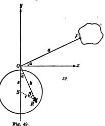
(und  $W_3$ ),  $R_1 d\psi = dx_0$  ihre Abwicklung (gleich dem Fortrücken des Drehpunktes O des Fahrarms in der Richtung der x-Achse), so dreht sich das mit ihr verbundene konische Zahnrad, das an der Berührungsstelle mit dem Scheibenrad den Radius  $R_3$  haben
