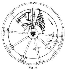
der Scheibe ein zungenartiges Sperrstück. Auf jeder Achse f befindet sich nämlich am zentralen Ende eine Scheibe mit 10 nach dem Innern der Maschine gerichteten Stiftchen. Wenn die Achse f über sämtliche Zähne hinweggegangen ist und das Rädchen z die vorgeschriebene Drehung vollführt hat, so schiebt sich das Sperrstück zwischen die Stiftchen und hält nun die Achse fest, damit sie sich nicht weiter drehen kann.
