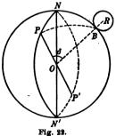
ihre Achse um den Winkel  $d\varphi$ , so bewegt sich der Berührungspunkt *B* auf einem kleinen Kugelkreise mit dem Radius  $r \sin \delta$ und beschreibt einen Bogen  $r \sin \delta d\varphi$ . Die Bewegung der Rolle wird teils eine rollende, teils eine gleitende sein und nur die erstere hat eine Drehung der Rolle zur Folge. Wenn wir den Winkel *PBN*
