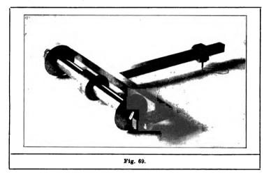
Ebenfalls zwei symmetrisch an der Stange angebrachte Schneiderollen besitzt das Präzisions-Stangenplanimeter von Th. Pregél (vgl. Zeitschr. f. Instrumentenk. 28, 373 und 31, 373).
