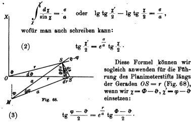
Hiermit ist also  $\varphi$  aus  $\Phi$  erhalten. Wir lassen nun den Stift von S nach S' fahren. Um die Änderung  $d\varphi$  von  $\varphi$  zu erhalten, stellen wir daher eine der Gleichung (1) entsprechende auf. Bezeichnen wir vorübergehend den Winkel, den SS' und das Kreisbogenelement  $SS'' = rd\vartheta$  untereinander einschließen, mit  $\psi$ , so ist
