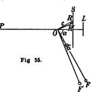
PL = l senkrechten Richtung verschiebt, so daß die Verschiebung der Meßrolle in dem zum Schlitten parallelen (horizontalen) Durchmesser der Scheibe stattfindet, wenn der Fahrarm sich um O dreht.
