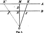
Die Prüfung des Rechenschiebers wird sich der Hauptsache nach auf das Zusammenfallen der Anfangs- und Endstriche der Teilungen auf Ober- und Unterseite der Zunge mit denen der Stabteilungen erstrecken. Auch muß das Zusammenfallen der Striche der gleich geteilten Skalen und zugleich die zur Skalenrichtung senkrechte Lage des Läuferstrichs geprüft werden. Es kommen zuweilen auch Teilungsfehler an einer einzelnen Stelle vor, die am ehesten durch Proberechnungen entdeckt werden.
