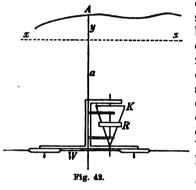
eine Stange geführt, die senkrecht zum Lineale lag; an dieser Stange befindet sich der Fahrstift F, mit dem man die gegebene Figur umfährt. Führt man den Fahrstift um ein Stück dx parallel zum Lineal, so verschiebt sich der Wagen um dasselbe Stück dx und der Kegel dreht sich infolge der Reibung an der Unterlage um einen Winkel  $d\varphi$ . Wenn der Radius seines Grundkreises k ist, so beträgt die Drehung  $d\varphi = \frac{dx}{k}$ . Auf dem Kegel liegt die
