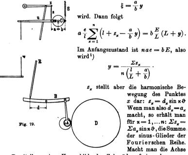
*D* mit ihren einen Konus bildenden Zahnrädern frei, so kann man mit Hilfe eines langen Getriebes alle Exzenter auf einmal um 90<sup>0</sup> drehen und erhält dann, wenn man  $d_x = b_x (x = 1...n)$  macht,
