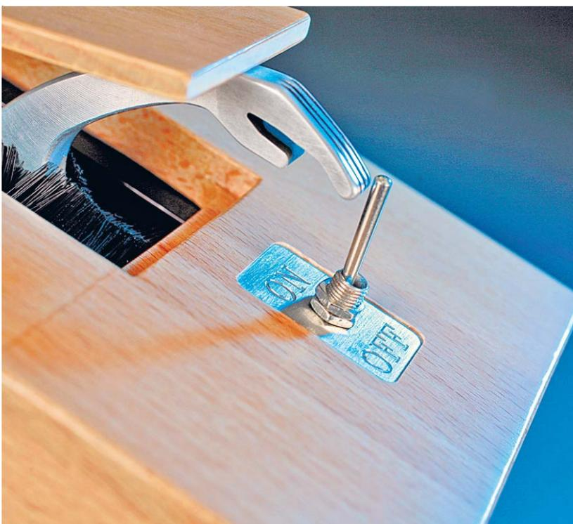
Nachbau von Shannons legendärer „Ultimate Machine“. Nach dem Betätigen des Einschaltknopfes öffnet eine Klappe, eine Hand erscheint und schaltet den Knopf auf Aus und verschwindet wieder im Kasten.
