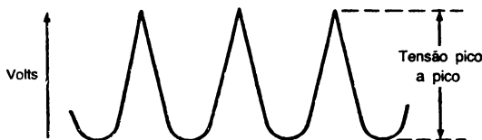
Figura 1.2 — Amplitude pico-a-pico. Este é o tipo de medição mais útil no caso dos sinais digitais, e deve ser realizada recorrendo a um osciloscópio.
