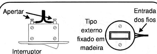
Figura 125: Instalando um interruptor de maior corrente.
