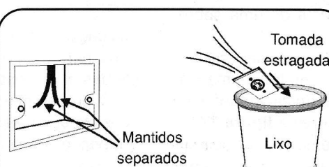
Figura 82: Separe os fios e jogue fora a tomada danificada.
