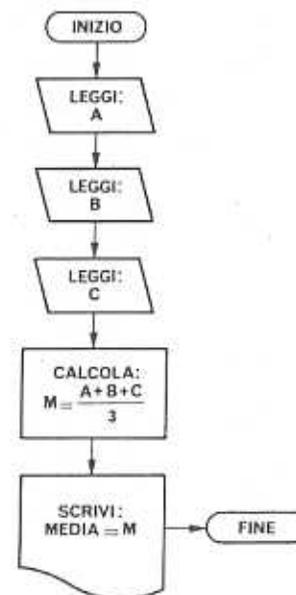
Fig. 4.2. Diagramma a blocchi media 3 numeri
