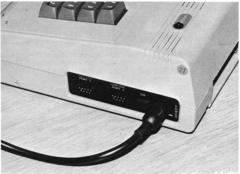
Figura 1.3. Collegamento del cavo di alimentazione al C-64 sulla destra dell'interruttore di accensione.
