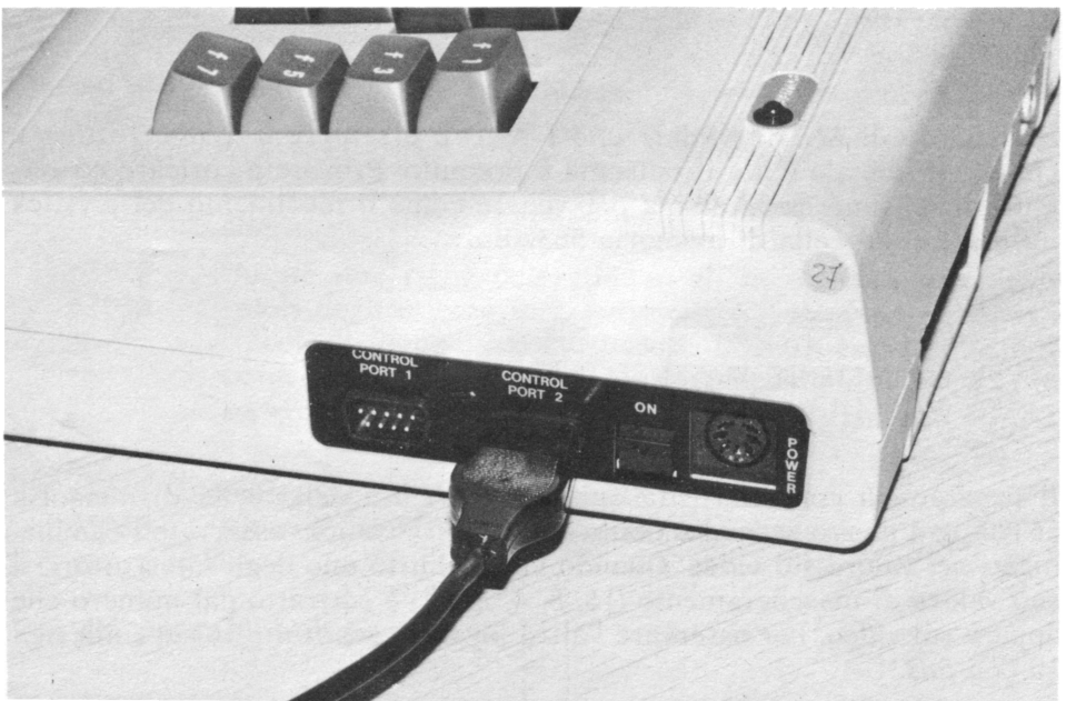
Figura 5.2. Collegamento del joystick al C-64.
