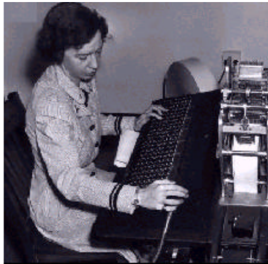
Figura 51 - Grace M. Hooper perfurando uma fita para programar o Harvard Mark I
