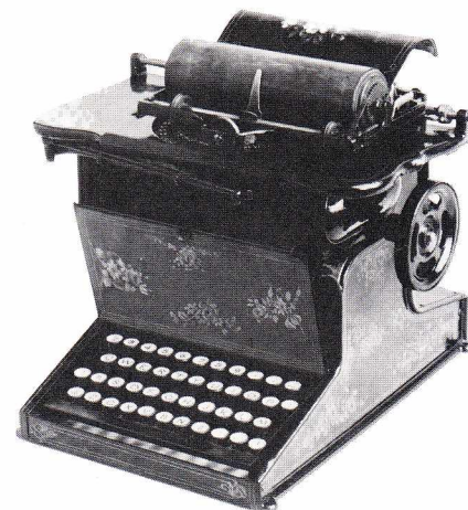
Lançada em 1873, a máquina de Sholes & Glidden, pioneira das máquinas de escrever, combinava um desenho atraente com recursos de operação pouco adequados. A máquina tinha tipos suspensos que batiam no rolo de baixo para cima, tornando impossível para o operador ler o que havia teclado, a não ser que erguesse a estrutura do carro.
