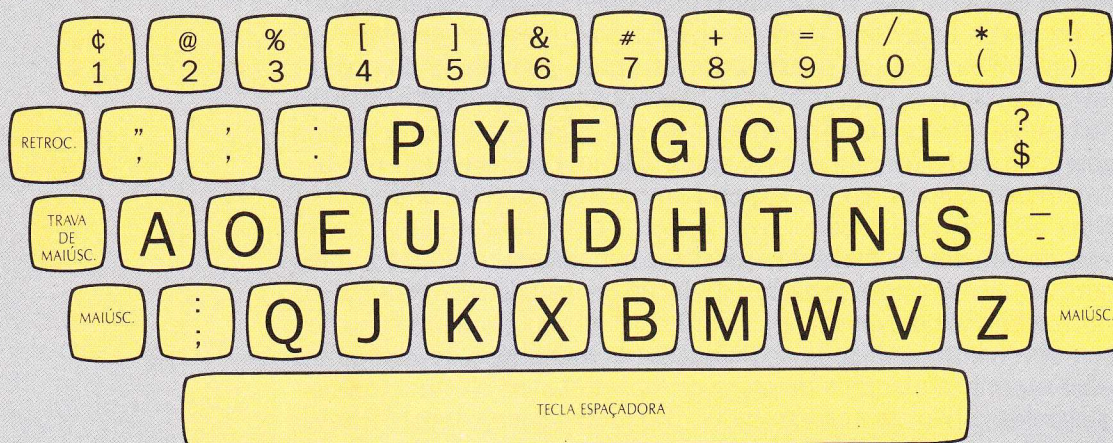
O teclado Dvorak coloca as letras usadas com maior freqüência na linha de descanso.
