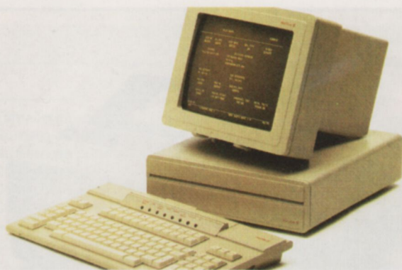
El terminal 3111 está formado por tres elementos principales: un monitor de 12", un controlador de pantalla y un teclado. Su diseño lo hace fácilmente adaptable a una gran variedad de puestos de trabajo.
