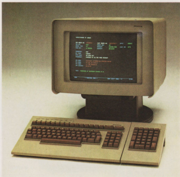
La unidad de pantalla 4112 permite trabajar con cuatro colores: rojo, azul, verde y blanco, y está diseñada para configuraciones en racimo (cluster). Un conmutador permite seleccionar la presentación en pantalla entre cuatro colores o dos colores.
