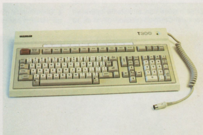
El teclado, de perfil extraplano e independiente, está formado por 103 teclas e incluye las características de una máquina de escribir, un teclado numérico separado, 10 teclas programables, y teclas de edición y funciones varias.
