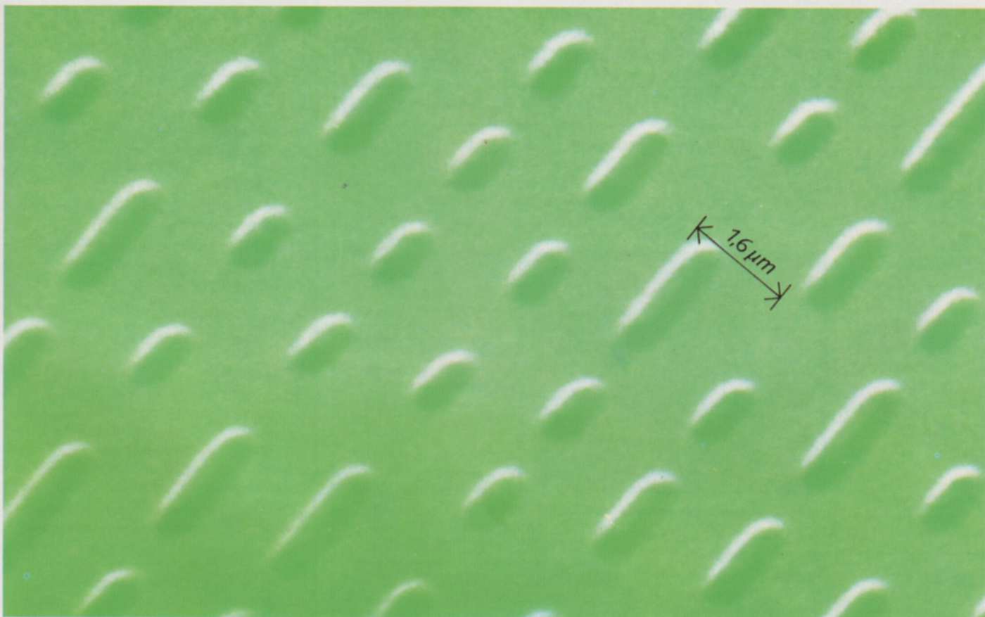
Microfotografía electrónica que muestra los agujeros realizados por un láser sobre una delicada película de metal. La distancia entre los agujeros es de 1,6 \mu\text{m} .
