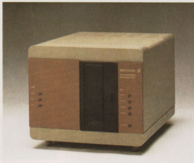
El procesador de comunicaciones 4103 controla la comunicación entre un ordenador y sus terminales, así como entre terminales. La unidad de disco se utiliza como memoria secundaria.
