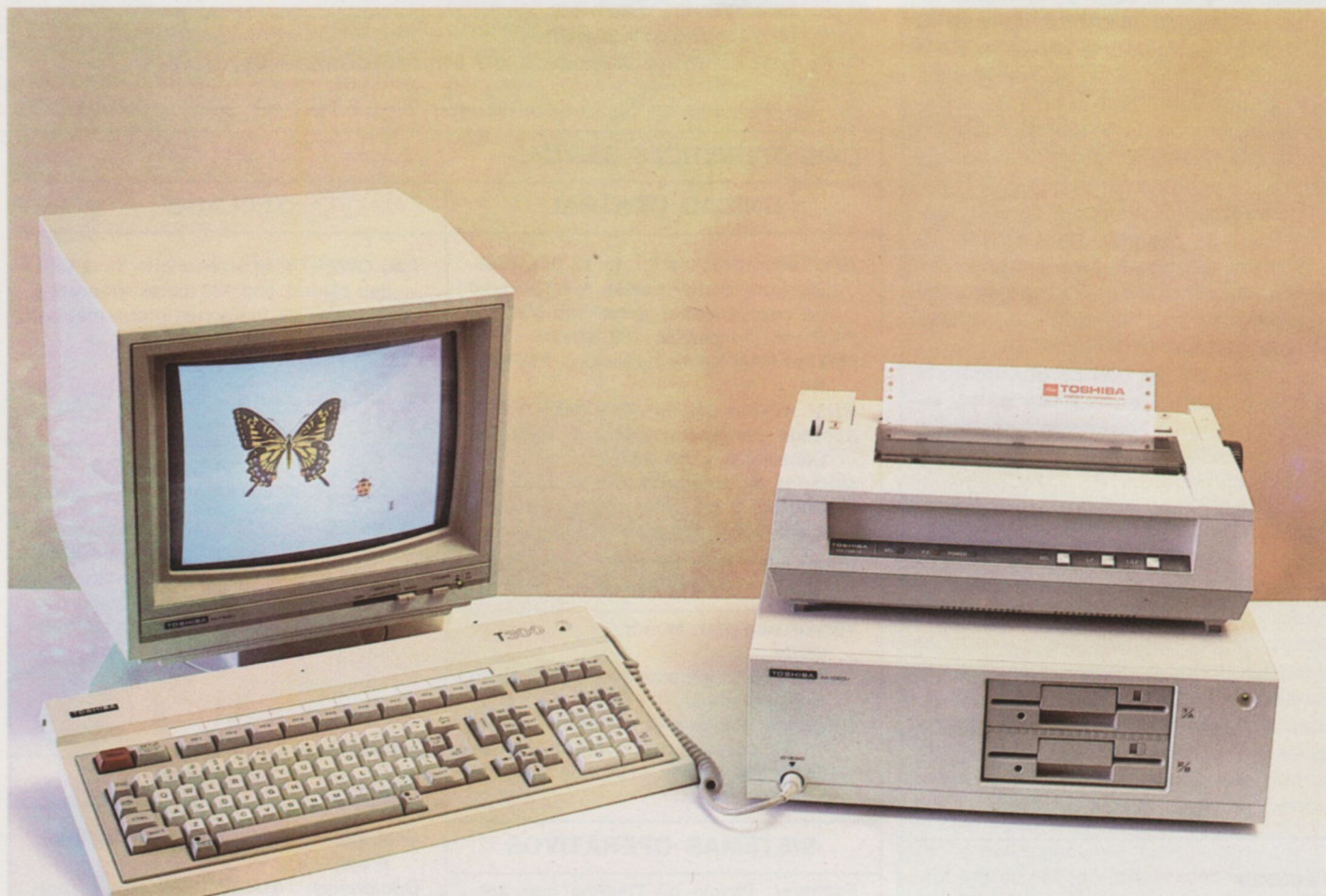
El microordenador TOSHIBA T300 es un equipo especialmente diseñado para aplicaciones de gestión o científico-técnicas, que está dotado de toda la potencia de cálculo que le confiere su microprocesador de 16 bits.
