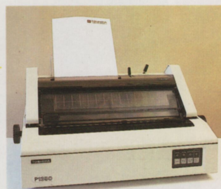
La impresora P1350 está situada en la gama alta de las suministradas por el fabricante, disponiendo de un cabezal de 24 agujas que permite una escritura de alta calidad (imitación margarita) a 78 c.p.s.
