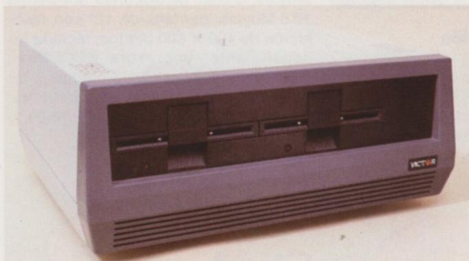
La unidad central está basada en el 8088, un microprocesador de 16 bits de la firma Intel.
