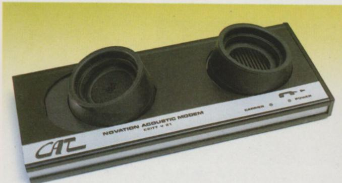
El CCITT CAT es un acoplador acústico o periférico adecuado para la transmisión de datos a través de la línea telefónica.
