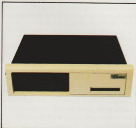
Los discos magnéticos forman parte de los soportes magnéticos de información más difundidos y utilizados en los sistemas ordenadores. En la foto aparece una unidad de disco rígido de tecnología Winchester.
