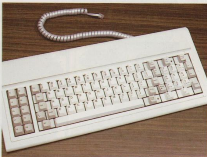
Esta máquina se suministra con dos modelos de teclados. Uno de ellos es idéntico al que incorpora el IBM PC.
