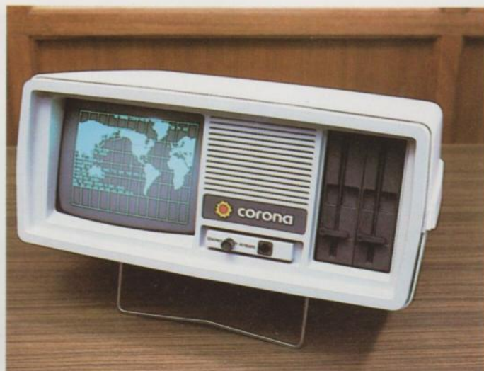
El Corona se suministra también en versión portátil. La pantalla, en este caso, está alojada junto a la CPU y tiene una diagonal de 9 pulgadas.
