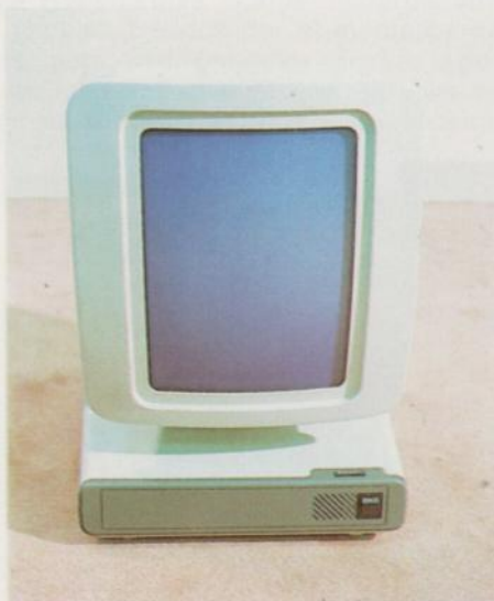
Uno de los monitores más originales del mercado: la pantalla gira 90 grados. En posición vertical el monitor presenta los textos en formato folio.
