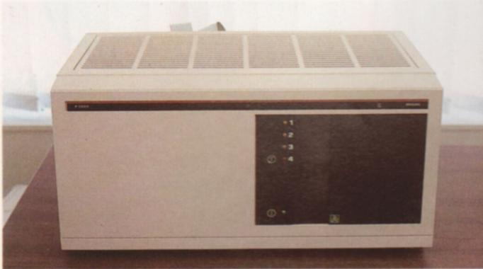
La unidad central se compone de un microprocesador Z-80 A, y de dos a cuatro microprocesadores secundarios, dependiendo del número de puestos de trabajo asociados al sistema.
