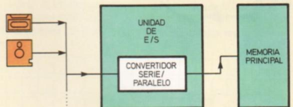
El convertidor serie/paralelo se utiliza en la transmisión de información desde periféricos como casetes o disquetes, a la memoria principal de un sistema de ordenador.
