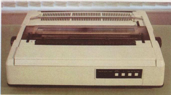
Philips propone, para este sistema, dos tipos de impresoras de matriz de puntos. La P1550, de 7x9 puntos, imprime a una velocidad de 120 caracteres por segundo. El modelo P2934 imprime en dos formatos: uno de 9x9 puntos, y el segundo de 18x25.
