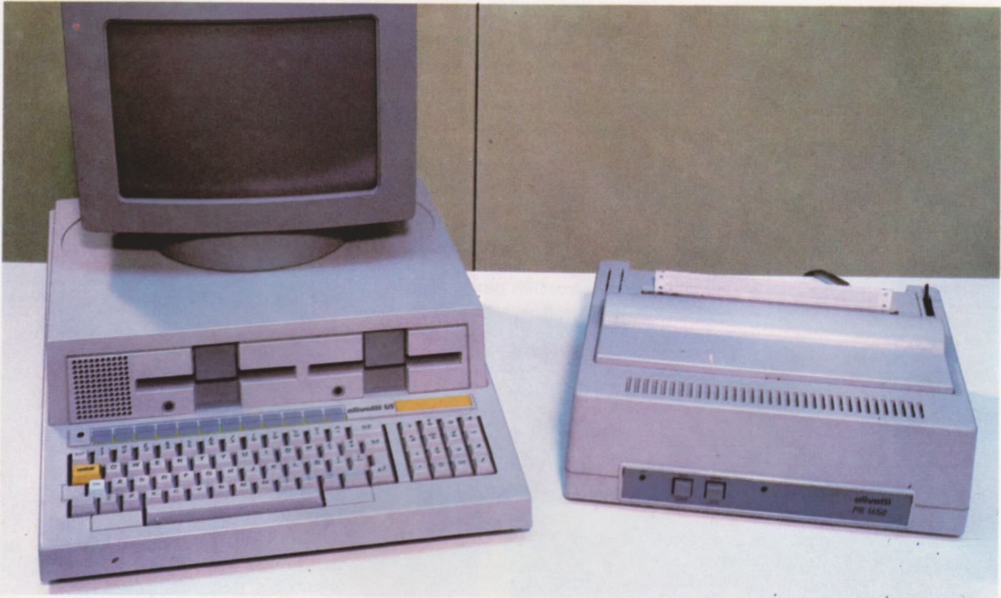
El programa de tratamiento de textos Olivord se desarrolla sobre un ordenador Olivetti M-20. Para su ejecución es preciso dotar a este sistema de una unidad doble de discos flexibles y una impresora.
