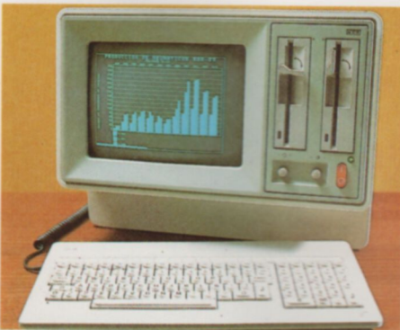
El teclado incorpora 120 teclas, 20 de las cuales son de función. Estas últimas se programan por el usuario, y su contenido se almacena en el disquete que contiene el sistema operativo.
