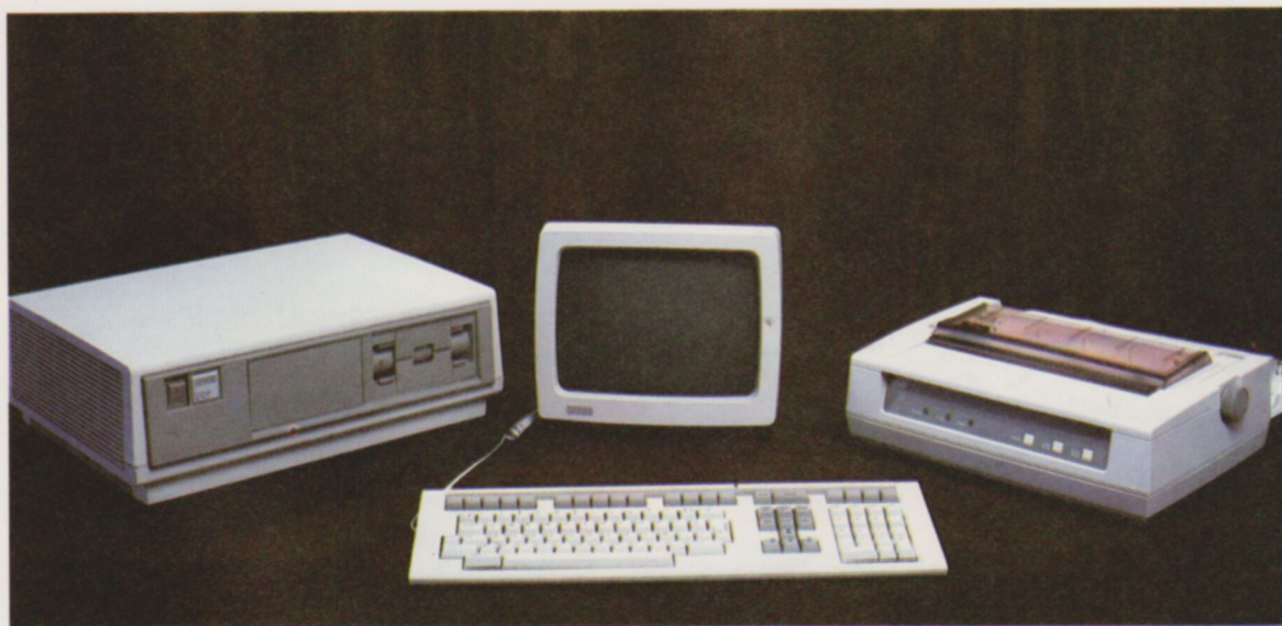
La configuración requerida para el desarrollo de esta aplicación se compone de un ordenador Rainbow 100 con unidad central, teclado, pantalla y doble unidad de disco flexible de 5,25 pulgadas.
