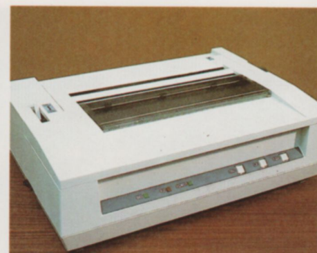
El fabricante ofrece dos modelos distintos de impresoras matriciales acoplables por este sistema. Ambas pueden conectarse a un interface tipo Centronics, o, bien RS-232C.
