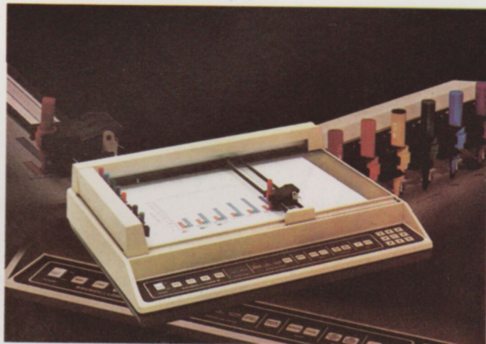
Una de las posibilidades más atractivas del modelo DMP-40 es su posibilidad de actuar como digitalizador, bajo petición del panel frontal.
