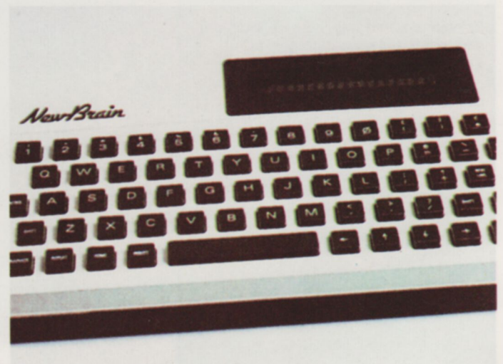
El sistema operativo CP/M se ha incorporado a ordenadores de todos los tamaños. El microordenador New Brain, por ejemplo, almacena, en un Kbyte de memoria residente, una variante de este sistema.
