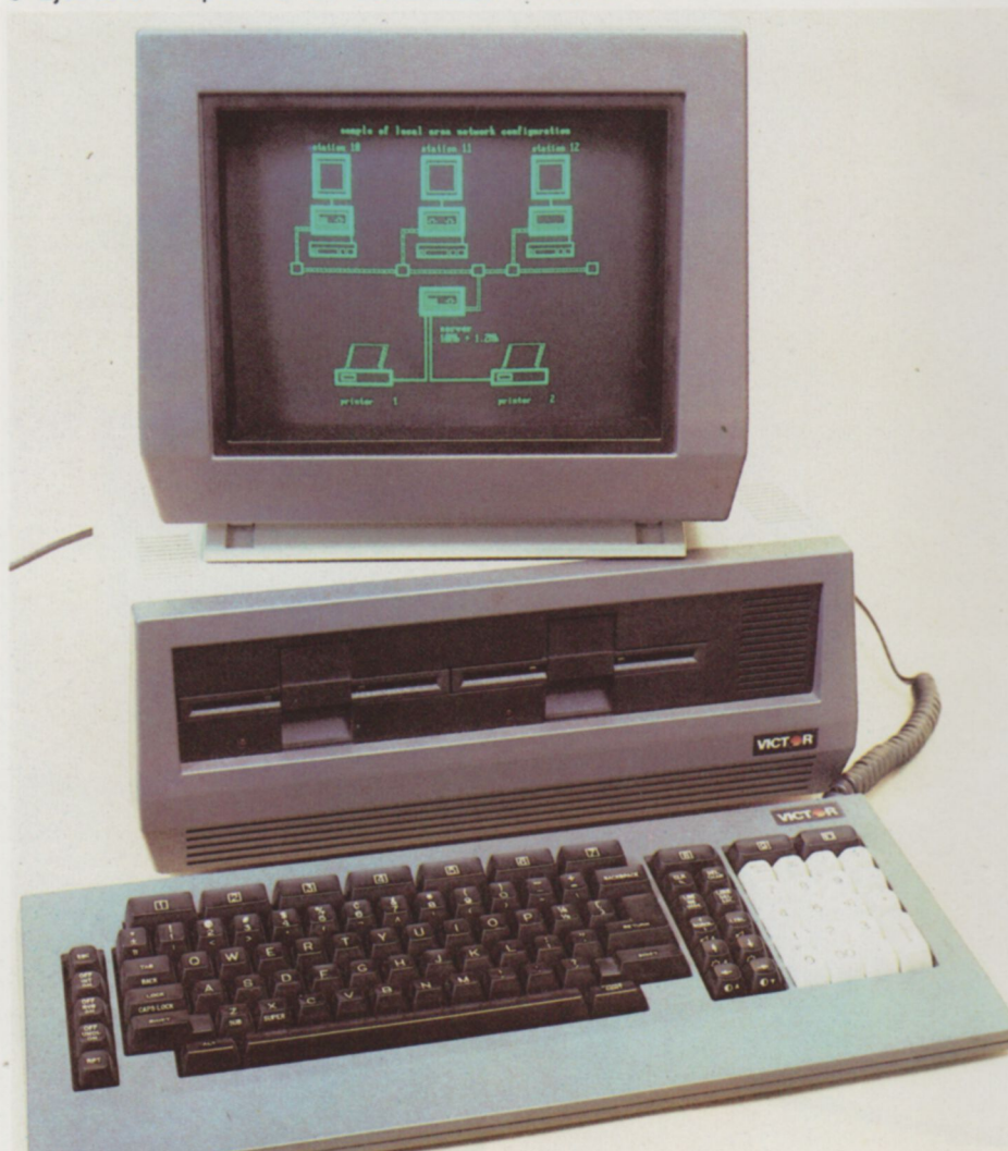
La versión CP/M 86 es empleada por ordenadores de 16 bits. Este ordenador incorpora el microprocesador 6088 y se gestiona mediante esta variante de CP/M.
