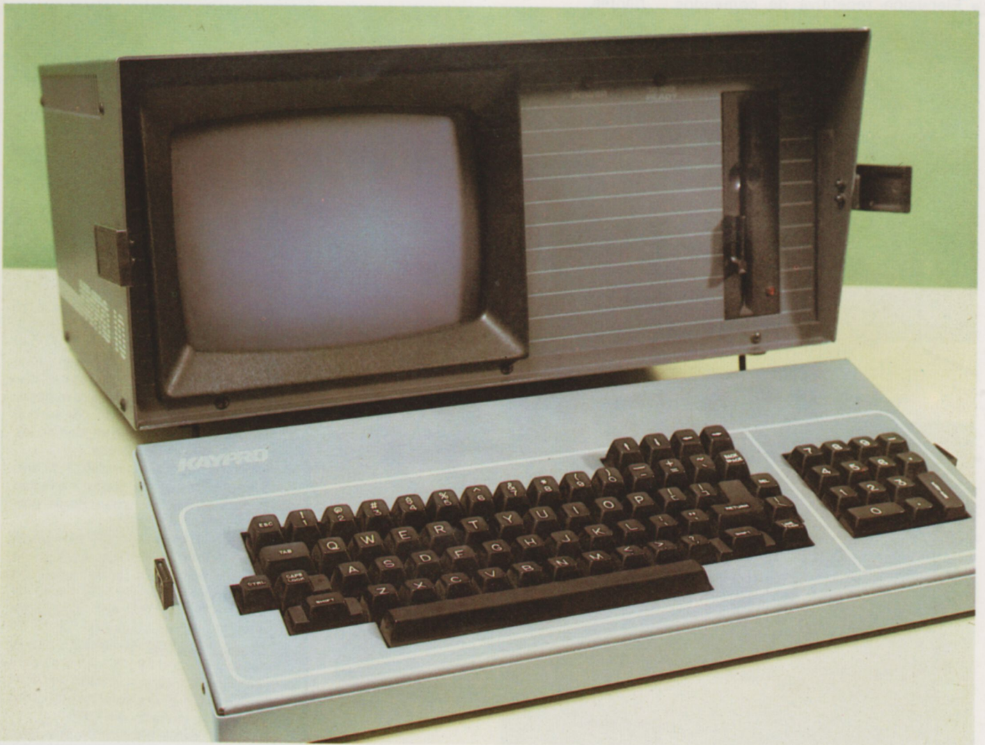
Los ordenadores portátiles basados en el microprocesador Z-80 se gestionan mediante este sistema operativo. El ordenador de la figura utiliza la variante CP/M 2.2.
