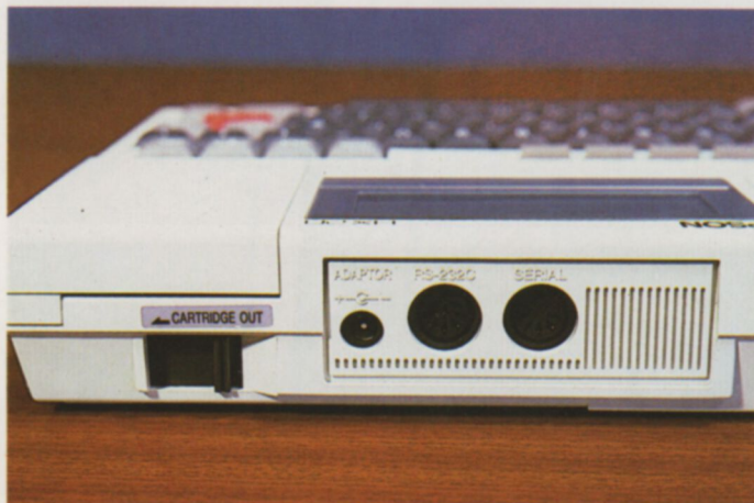
Detalle de los conectores frontales del sistema: conectores DIN para los interfaces RS 232 y Serie, enchufe para el adaptador de corriente continua y tecla para la extracción del microcasete.
