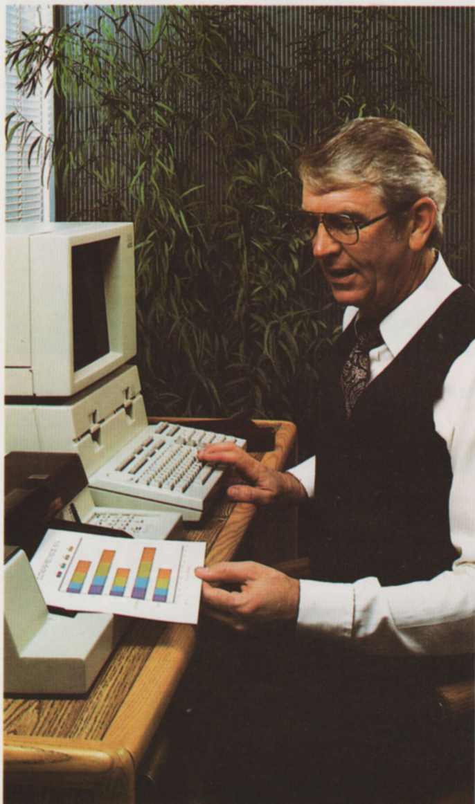
El interface RS/232 del plotter HP 7470 permite su conexión a un gran número de ordenadores, entre ellos a los Apple II y III, para los que se ha desarrollado un amplio catálogo de software de gráficos.
