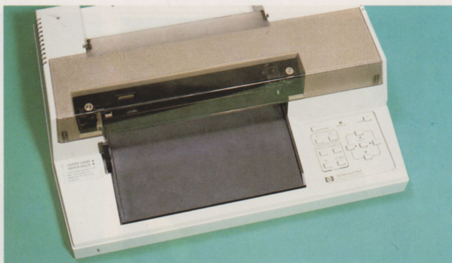
El HP 7470 es un plotter de sobremesa dotado de dos plumas y cinco juegos de caracteres internos.
