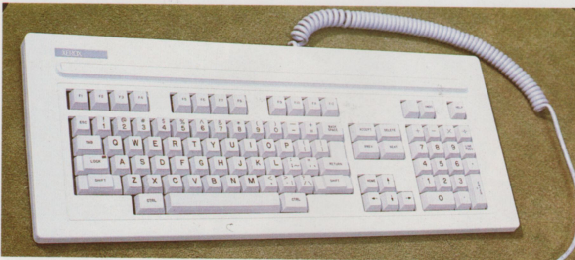
El teclado, independiente de la unidad central, consta de un total de 98 teclas. Además de los caracteres ASCII, es capaz de generar todas las mayúsculas y minúsculas del alfabeto castellano.
