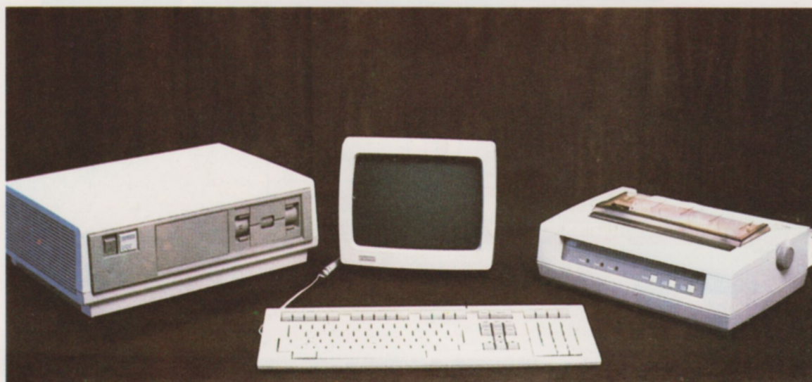
El paquete de aplicación Wordstar se ha evaluado, implementándolo en un ordenador Rainbow-100, dotado del sistema operativo CP/M y con dos unidades para discos flexibles de 5 y 1/4".
