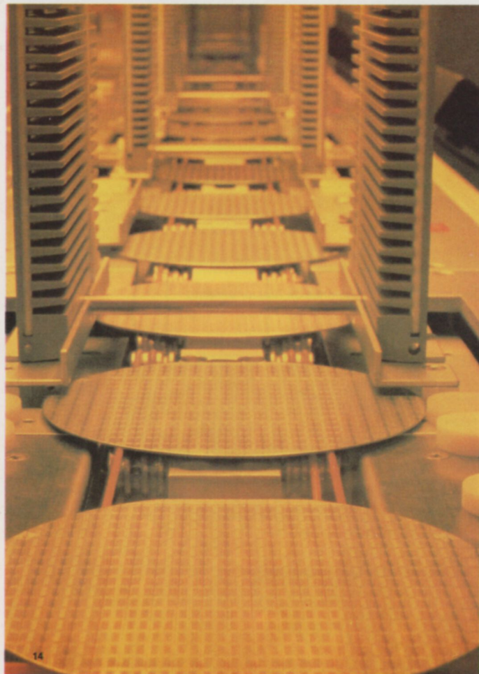
Durante la fase de fotograbado, una simple mota de polvo depositada sobre la oblea del material semiconductor, puede llegar a estropear alguno de los circuitos. Esta fase se realiza en unas condiciones ambientales muy cuidadosas.
