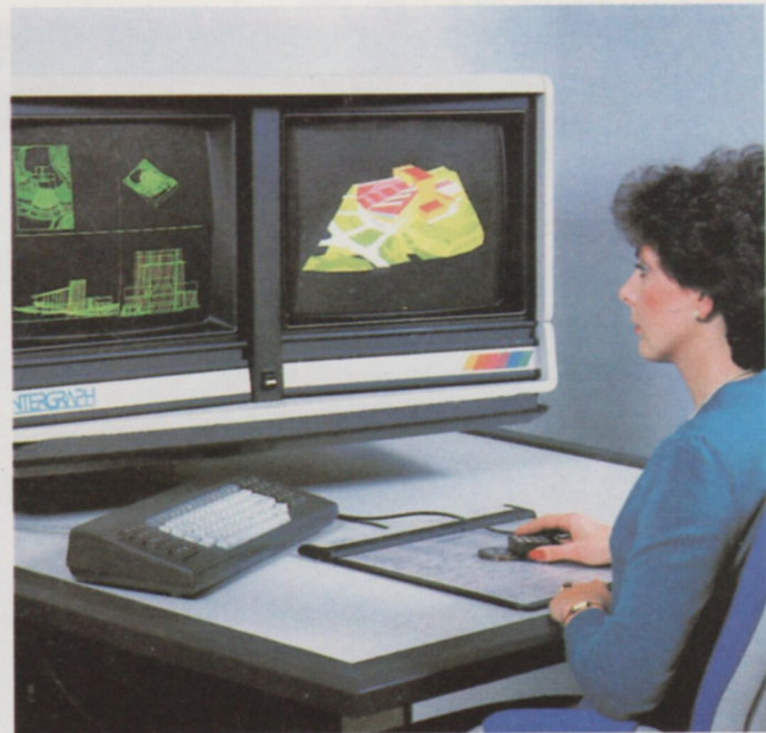
Las nuevas técnicas de diseño asistido por ordenador incluyen, además de la tarea de creación de gráficos y su rotación según los tres ejes cartesianos, de un efecto «zoom» que conserva la resolución gráfica, y de la posibilidad de acceder a paletas de múltiples colores.
