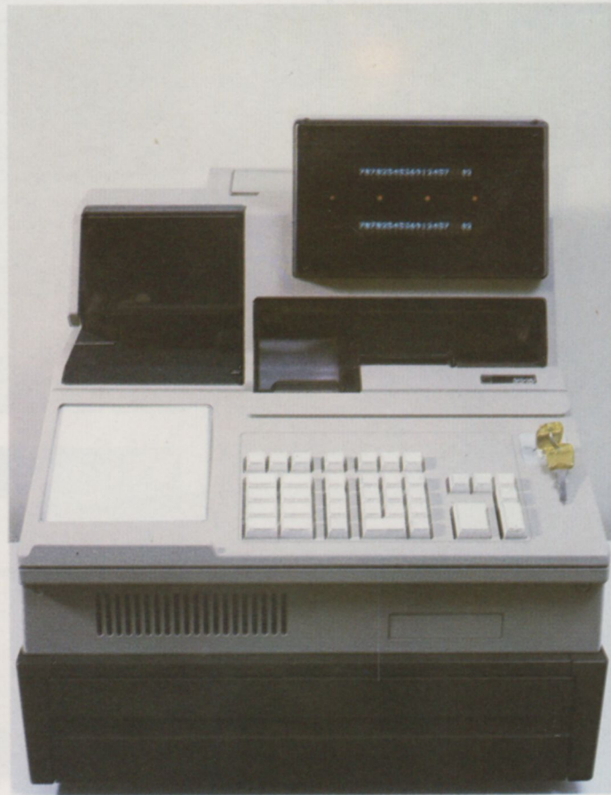
Terminal de punto de venta. Realiza automáticamente la transferencia del importe de una compra desde la cuenta del cliente a la del establecimiento.
