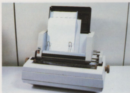
La conexión de cualquiera de los cuatro modelos de impresoras que ofrece el fabricante se realiza directamente, a través de un interface estándar RS/232-C.
