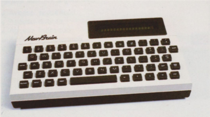
El teclado, de tipo QWERTY y con un total de 62 teclas, está incorporado en la misma caja de la unidad central. El visualizador alfanumérico (opcional) emplazado en la zona superior del mueble facilita la operación autónoma del equipo básico.
