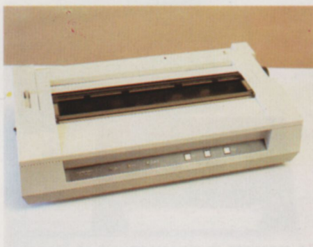
El modelo PA 7251 mejora las posibilidades de las restantes impresoras de la gama Toshiba, imprimiendo hasta 136 caracteres por línea.
