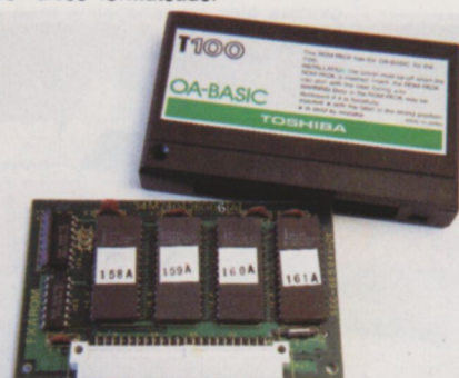
La capacidad de almacenamiento en línea del Toshiba T-100 puede incrementarse con la incorporación de cartuchos enchufables a la unidad central. La fotografía muestra un cartucho de ampliación ROM (ROM PACK).
