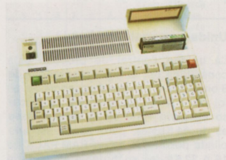
La unidad central del T-100 incorpora 32 Kbytes de ROM, ampliables a 64 Kbytes por medio de un cartucho enchufable al conector localizado en la parte superior derecha del equipo.
