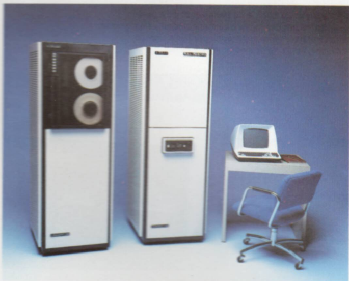
En la parte izquierda de la figura puede observarse una unidad de bobina. Es un periférico para el almacenamiento masivo de información en grandes sistemas informáticos, ya que ofrece una gran flexibilidad y fiabilidad en grandes volúmenes de datos.
