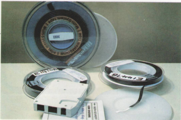
Hasta el momento se han normalizado dos anchos de cinta: media pulgada y cuarto de pulgada. Las primeras suelen llevar de cuatro a nueve pistas, mientras que las segundas alcanzan la cifra de 20 a 24 pistas.
