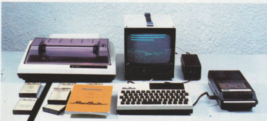
En la ilustración puede observarse un ejemplo de cómo se conecta una unidad de cassette convencional a un microordenador. Por regla general, los micros de bajo coste suelen llevar un interface incorporado para poder conectar estos dispositivos de almacenamiento.
