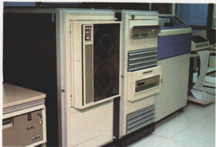
Las unidades de bobina no tienen razón de ser en sistemas pequeños, ya que su fiabilidad y flexibilidad se ven notablemente superadas por los sistemas de discos, tanto rígidos como flexibles.
