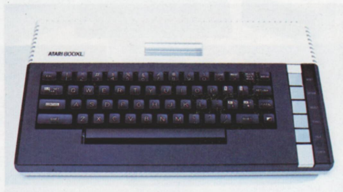
La fotografía muestra la unidad central del modelo ATARI-800 XL, idéntica al modelo 600 XL, pero con una RAM de 64 Kbytes en la versión básica.
