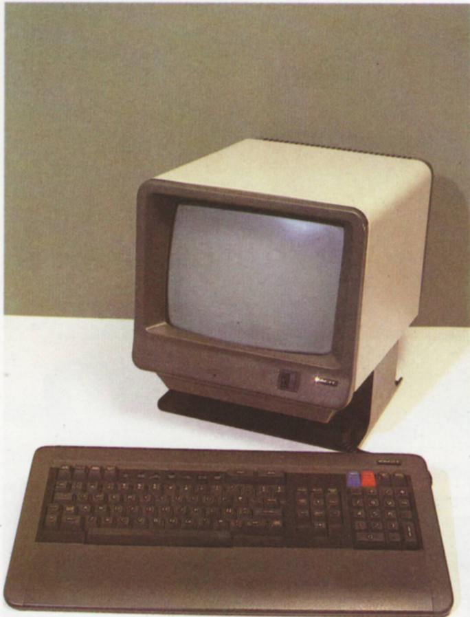
El terminal FACIT 4420, de diseño sobrio y funcional, está controlado internamente por un microprocesador de 8 bits del tipo F-8 de la firma Fairchild.
