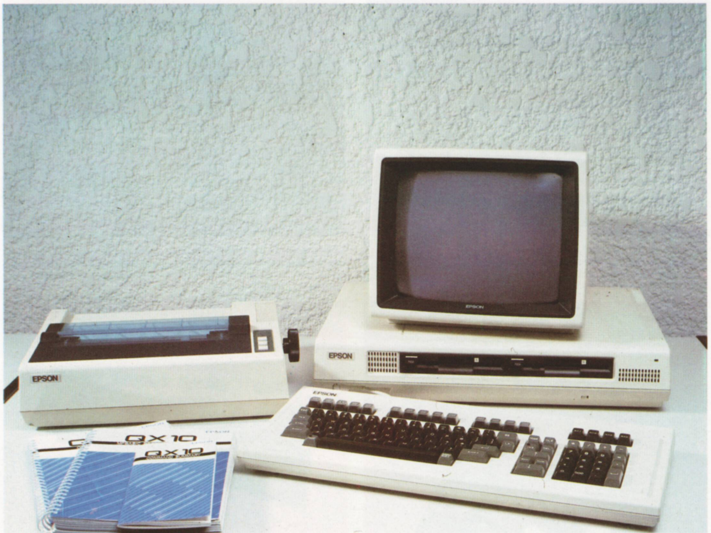
La unidad central del EPSON QX-10 puede soportar, aparte de la pantalla y el teclado, una impresora y una unidad doble de disquettes de 5 1/4" con 320 Kbytes de capacidad por disco.
