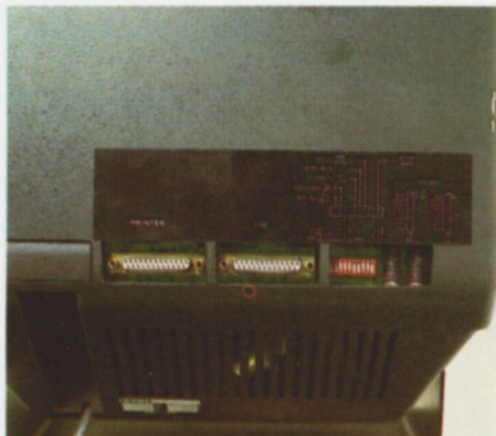
Panel posterior del terminal FACIT 4420, donde pueden observarse los distintos conectores de comunicación del sistema y la red de microconmutadores de selección.
