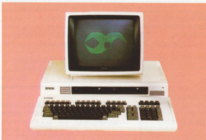
El EPSON QX-10 incorpora el sistema operativo MultiFonts CP/M y el lenguaje MultiFonts BASIC, que lo convierten en un ordenador personal potente y con múltiples prestaciones.
