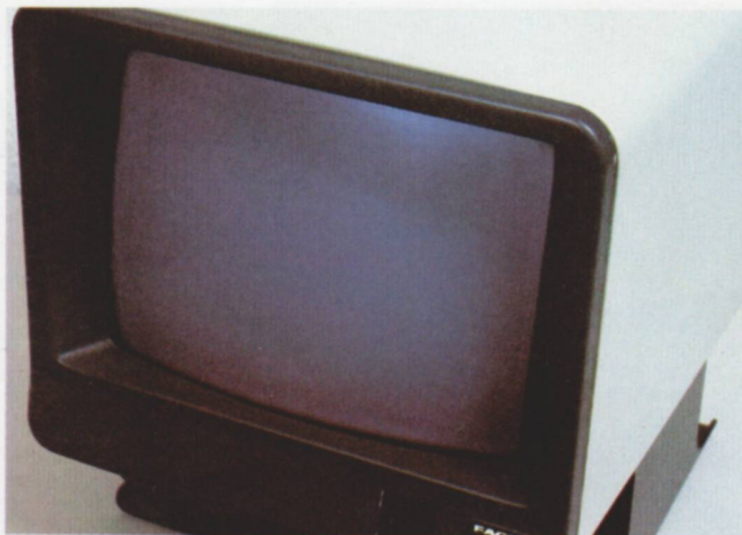
En la pantalla, de fósforo verde, de 12" de diagonal y un área de visualización de 8" x 6", pueden escribirse hasta 24 líneas de 80 caracteres, con una resolución por carácter de 7 x 10 puntos.
