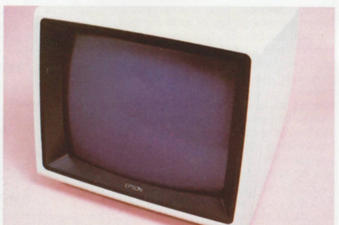
La pantalla del EPSON QX-10 es de 12", con una resolución de 640 puntos en horizontal y 400 en vertical. El sistema está preparado para soportar un monitor en color para la presentación de gráficos.
