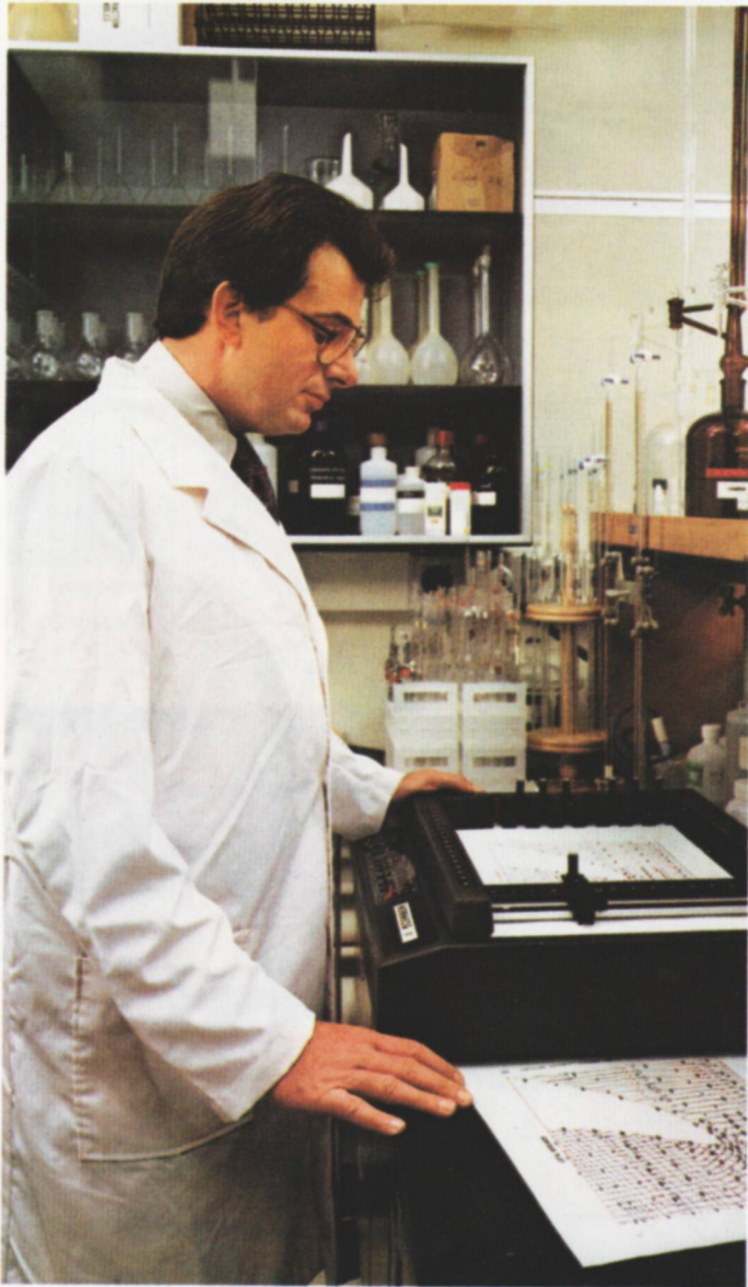
El modelo 81 es un plotter de sobremesa, de reducidas dimensiones, que incorpora ocho plumas de distintos colores para el trazado de gráficos sobre papel en formato DIN A-3.
