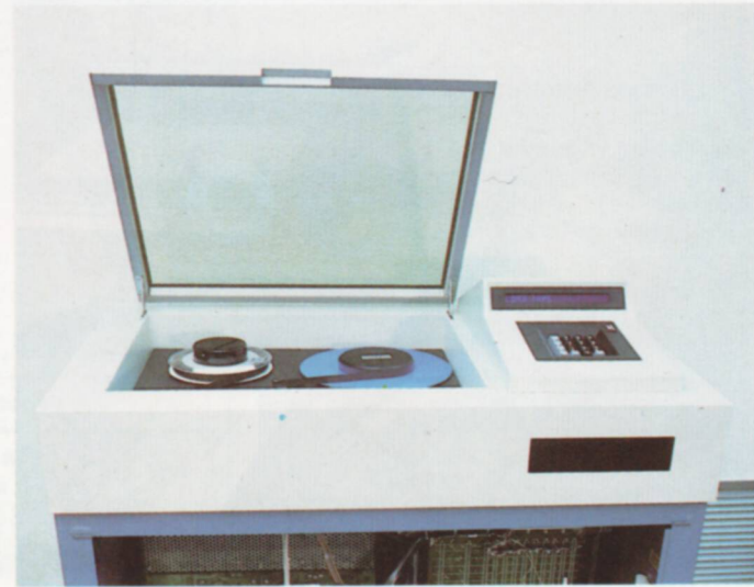
Los dos modelos de plotters de tipo «beltbed» analizados pueden operar asociados a diversos controladores Calcomp, por ejemplo, al controlador modelo 953 que aparece en la fotografía.
