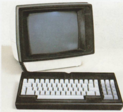
Consola o terminal: periférico de comunicación integrado por un dispositivo para la entrada de información (teclado) y una unidad periférica de salida (pantalla).
