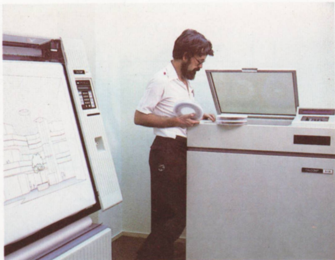
Al igual que el modelo 970, el plotter 965 es capaz de trazar gráficos sobre hojas cortadas de grandes dimensiones con la misma facilidad que un plotter de tambor.
