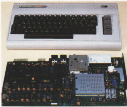
La unidad central de proceso está constituida por el microprocesador 6510 de MOS Technology, un chip microprocesador compatible con el ya clásico 6502 de la misma firma.
