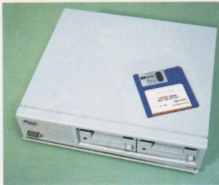
Unidades de minidisco: son periféricos de almacenamiento de características semejantes a las unidades de disco flexible, aunque ocupando menor espacio físico.
