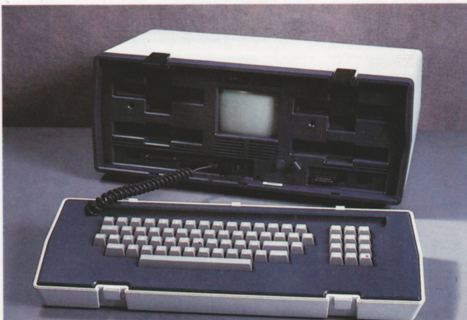
La aplicación SGI (sistema de gestión integrada) está diseñada para su ejecución en el microordenador OSBORNE 1. La configuración necesaria se limita al equipo básico complementado con una impresora.
