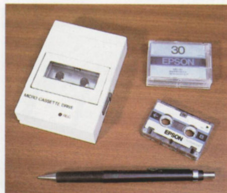
Unidad de minicinta: realiza una función análoga a la del magnetófono, si bien, es capaz de operar con mayor velocidad.
