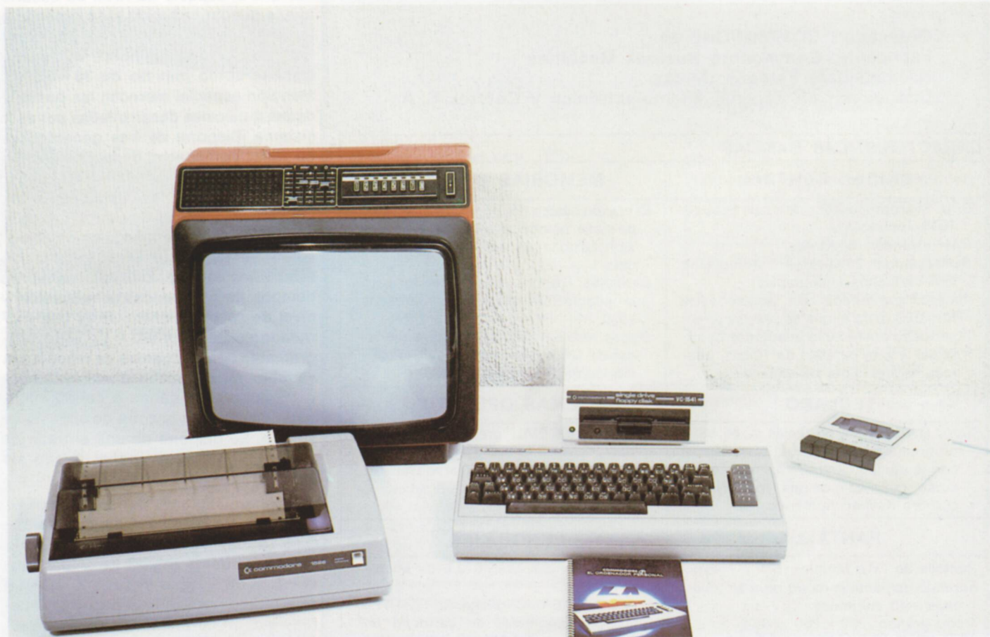
El Commodore 64 es un ordenador personal orientado, tanto a aplicaciones domésticas y juegos como a tareas de gestión. Esta segunda vertiente parte de su posibilidad de trabajar con el sistema operativo CP/M.
