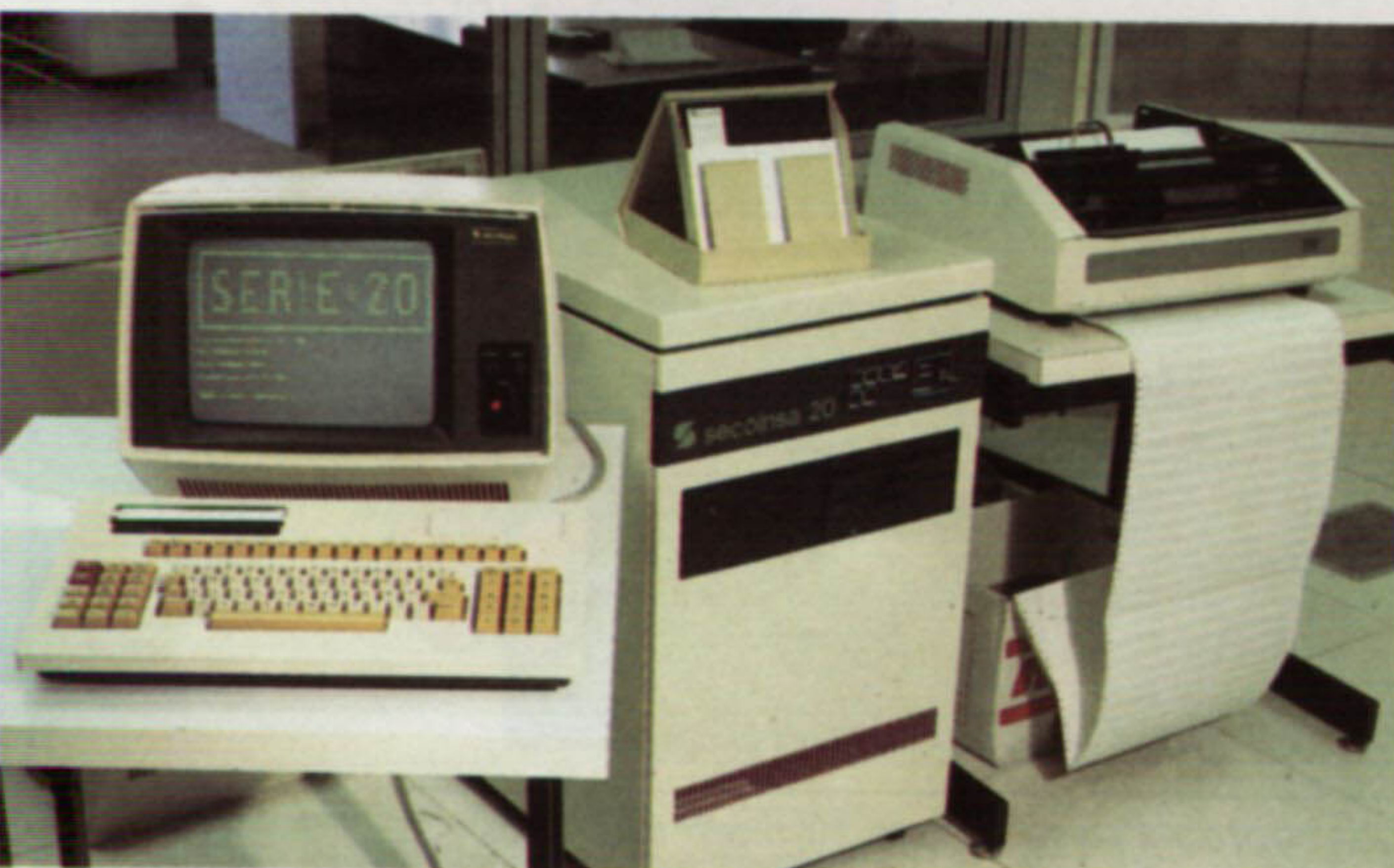
La explotación del paquete ELIPSE precisa de la configuración mínima formada por la unidad central, la unidad de disco flexible de 8", el disco rígido de 10 Mbytes, el terminal y la impresora.
