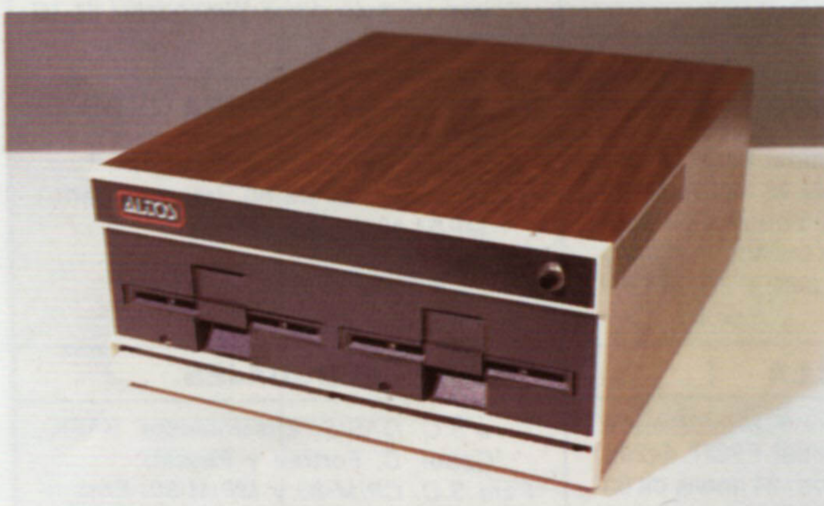
La unidad central es compacta y de reducidas dimensiones. El propio mueble incorpora dos unidades de disco (dos unidades para disquettes de 5 y 1/4" o una unidad de disquette y un disco rígido de 5 y 1/4 pulgadas con capacidad de 5 Mbytes).
