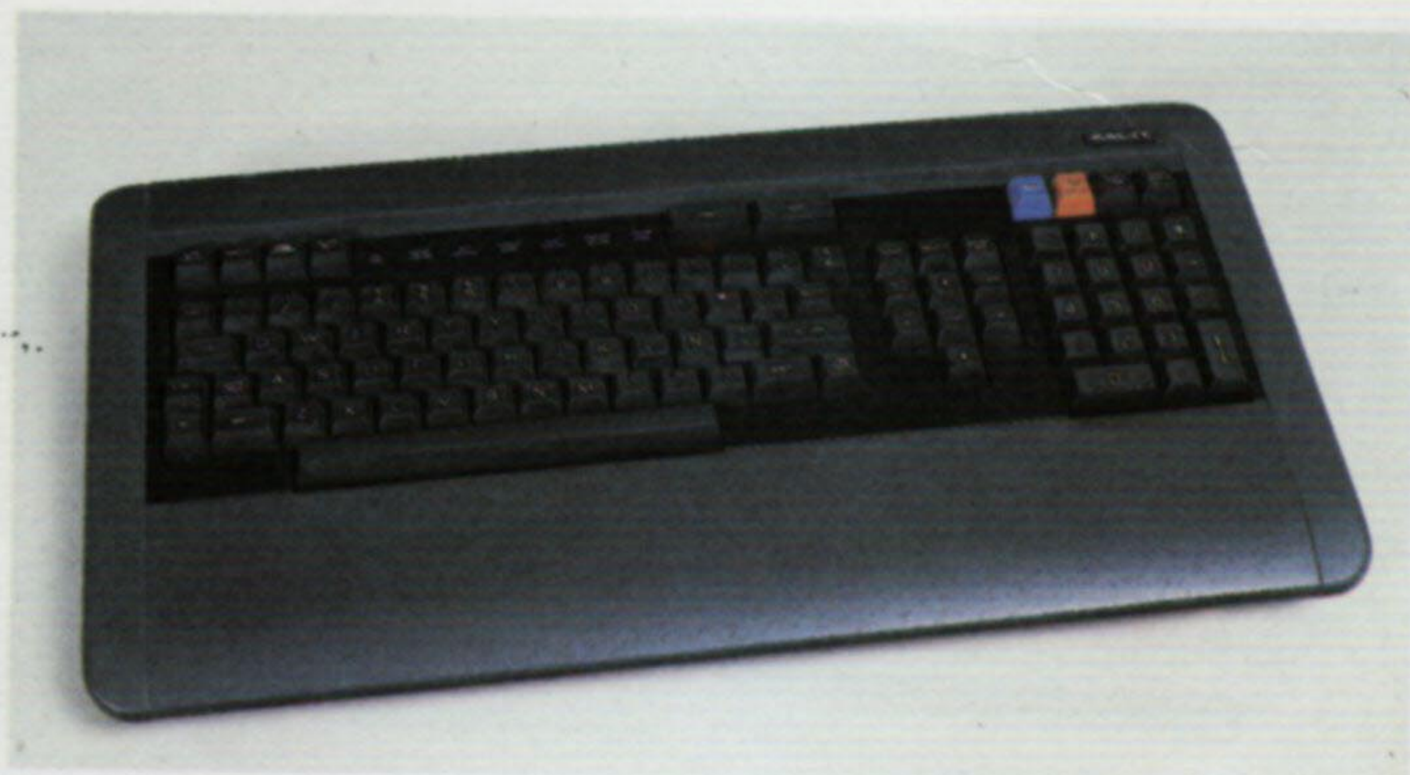
El teclado del terminal utilizado (FACIT 4420) es del tipo QWERTY y consta de un total de 96 teclas, distribuidas en varias zonas: teclado alfanumérico, teclado decimal, teclas de control de cursor y teclas para el control del terminal.
