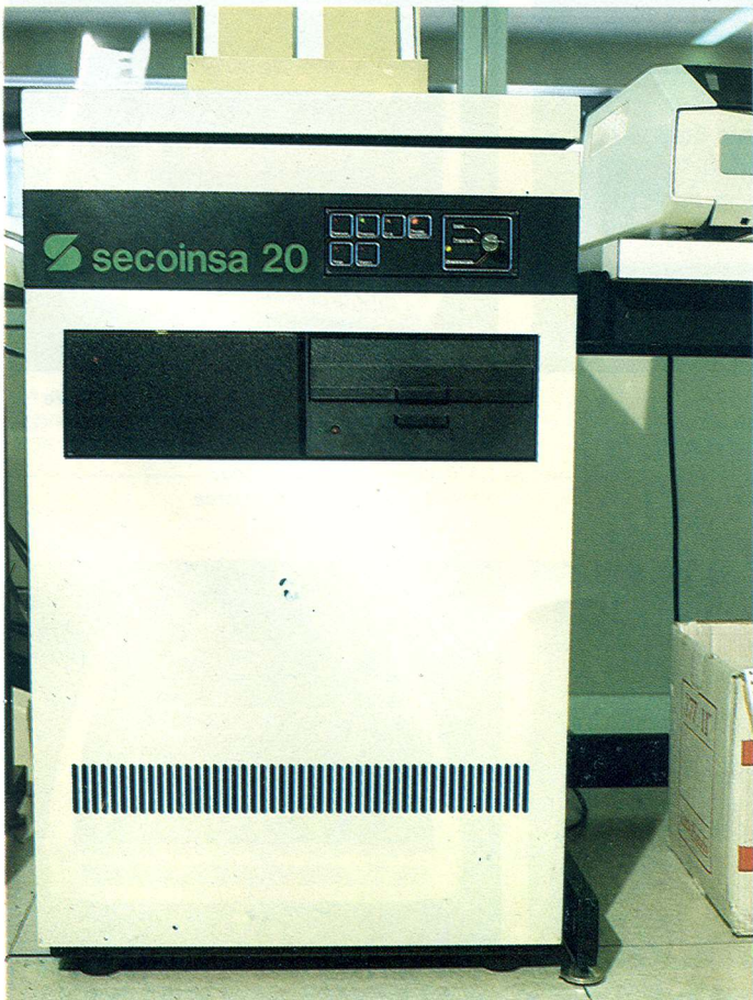
La unidad central se aloja en un mueble vertical, junto con dos unidades de disco (flexible de 8 pulgadas o rígido), la fuente de alimentación y las tarjetas para la expansión del sistema.
