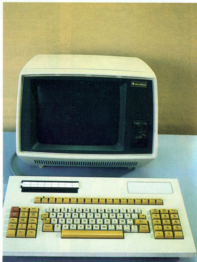
El terminal estándar que se suministra con el sistema es el IS 9502. Una de sus características más reseñables es que admite la conexión de una impresora local.
