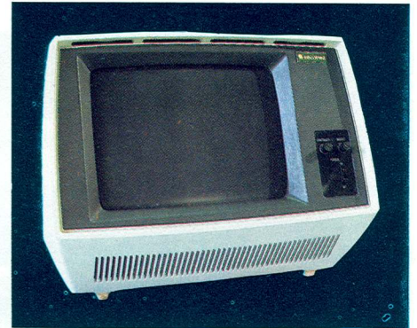
La pantalla de 12 pulgadas que forma parte del terminal estándar es monocromática de fósforo verde con una capacidad de 1.920 caracteres distribuidos en 24 líneas de 80 caracteres.
