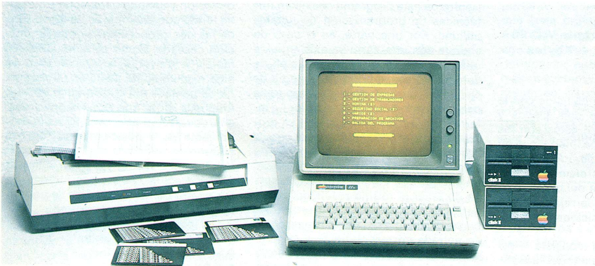
El paquete de aplicación está diseñado para su ejecución en el microordenador APPLE II, completado con dos unidades de disco flexible, monitor e impresora.
