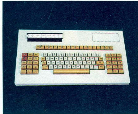
El teclado del terminal IS 9502 está distribuido en tres bloques: zona alfanumérica de tipo QWERTY, teclado numérico decimal y zona de teclas funcionales.
