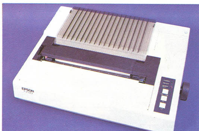
Una de las impresoras que ocupan la zona alta de la familia EPSON es la FX-80 cuya velocidad de escritura se sitúa en los 160 cps.
