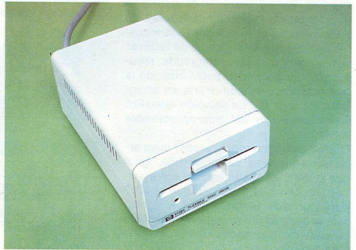
La mayor parte de los microordenadores recurren a unidades de disco flexible, de 5 y 1/4 o de 8 pulgadas, como memorias de masa.
