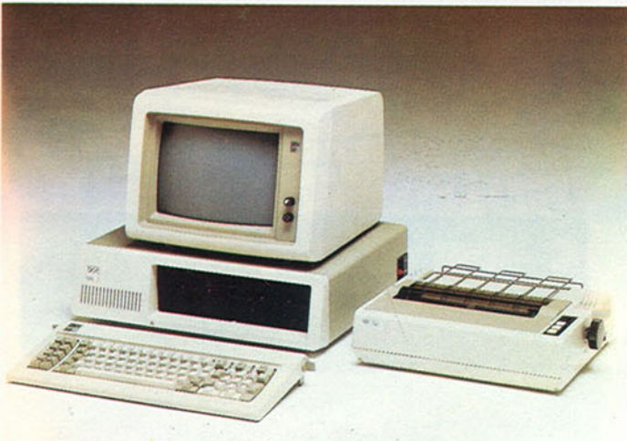
La configuración más estandarizada del IBM-PC consta de la unidad central, una unidad de disco flexible de 5 y 1/4 pulgadas, unidad de disco rígido de 5 Mbytes, teclado, monitor monocromo e impresora.
