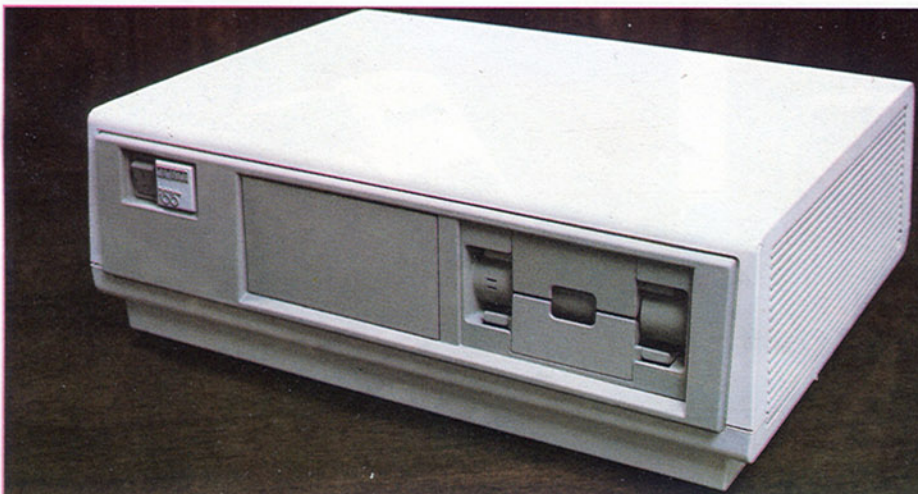
Unidad central de un microordenador para aplicaciones de gestión. En la zona derecha se observa la incorporación de una unidad de memoria de masa, concretamente un lector/grabador de discos flexibles
