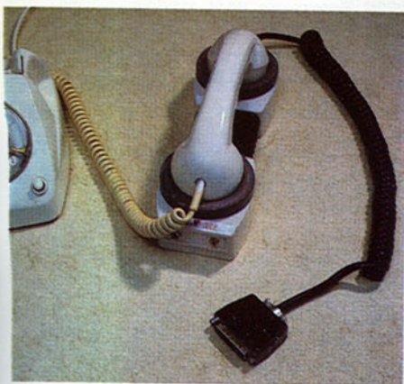
Los modems son periféricos de entrada y salida que permiten al ordenador comunicarse con otros equipos a través de una línea telefónica.
