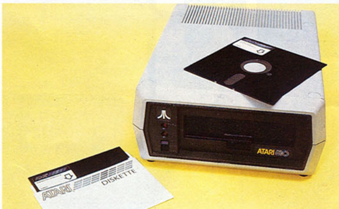
El periférico de almacenamiento de información más común en el campo de los microordenadores es la unidad de disco. Su cometido consiste en grabar o leer información en un disco flexible, normalmente, de 5 a 1/4 o de 8 pulgadas.
