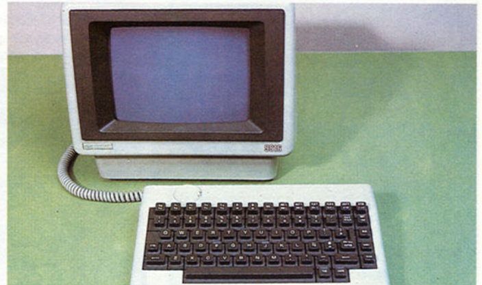
La conjunción de un teclado y un monitor o pantalla de video constituye el «terminal»: un periférico doble, de entrada (teclado) y salida (pantalla).
