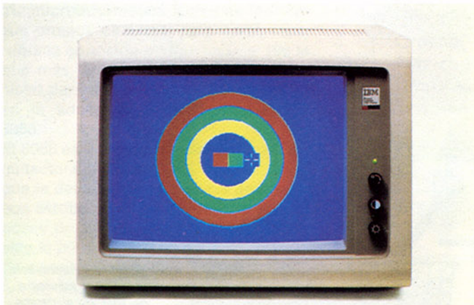
El monitor estándar del IBM-PC es monocromo de fósforo verde tipo P39, si bien, permite la opción de incorporar un monitor a color sobre el que pueden generarse hasta 8 colores de fondo y 16 de trabajo
