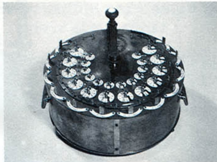
Calculadora diseñada y construida por Mattieu Hahn en 1779. Se cree que es la primera máquina de calcular capaz de realizar las cuatro operaciones aritméticas.
