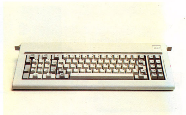
El teclado consta de un total de 83 teclas, agrupadas en tres bloques: la zona de caracteres alfanuméricos y de movimiento de cursor, el teclado numérico y la zona de teclas funcionales
