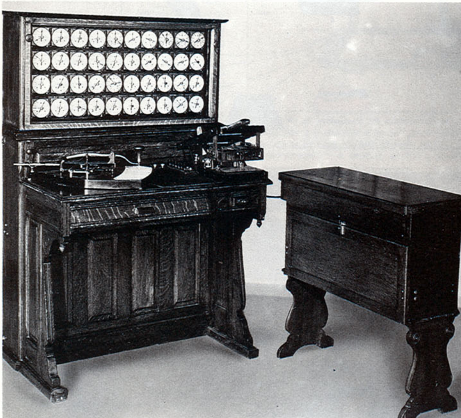
Máquina tabuladora eléctrica de Hollerith patentada en 1889. Dos veces más veloz que las restantes máquinas contemporáneas, la tabuladora eléctrica es la madre de las modernas máquinas de tratamiento de datos. Se utilizó en 1890 para elaborar el censo de los Estados Unidos de América.
