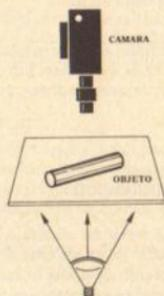
Fig. 3. Disposición de iluminación posterior.
