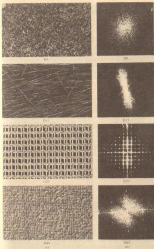
Fig. 2. Módulo de la transformada de Fourier (b) de imágenes texturadas (a).
