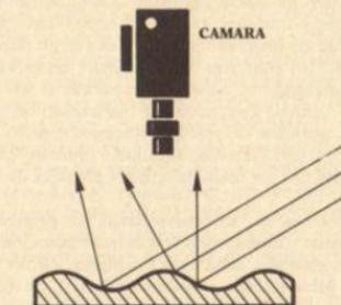
Fig. 5. Disposición de iluminación direccional.
