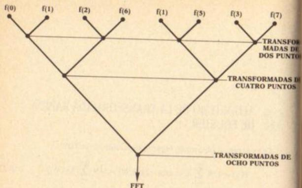
Fig. 1. Ordenación de los datos de la función  $\{f(0), f(1), \dots, f(7)\}$  para el cálculo de la FFT.
