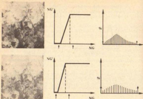
Fig. 3. Mejora lineal del contraste con saturación variable.
