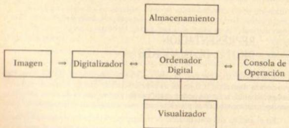
Fig. 1. Elementos de un sistema de procesamiento digital de imágenes.
