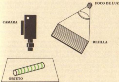
Fig. 4. Disposición de iluminación modulada.
