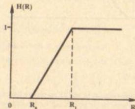
Fig. 14. Filtro paso-alto trapezoidal.
