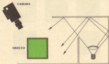
Fig. 2. Ejemplo de disposición de una iluminación difusa.
