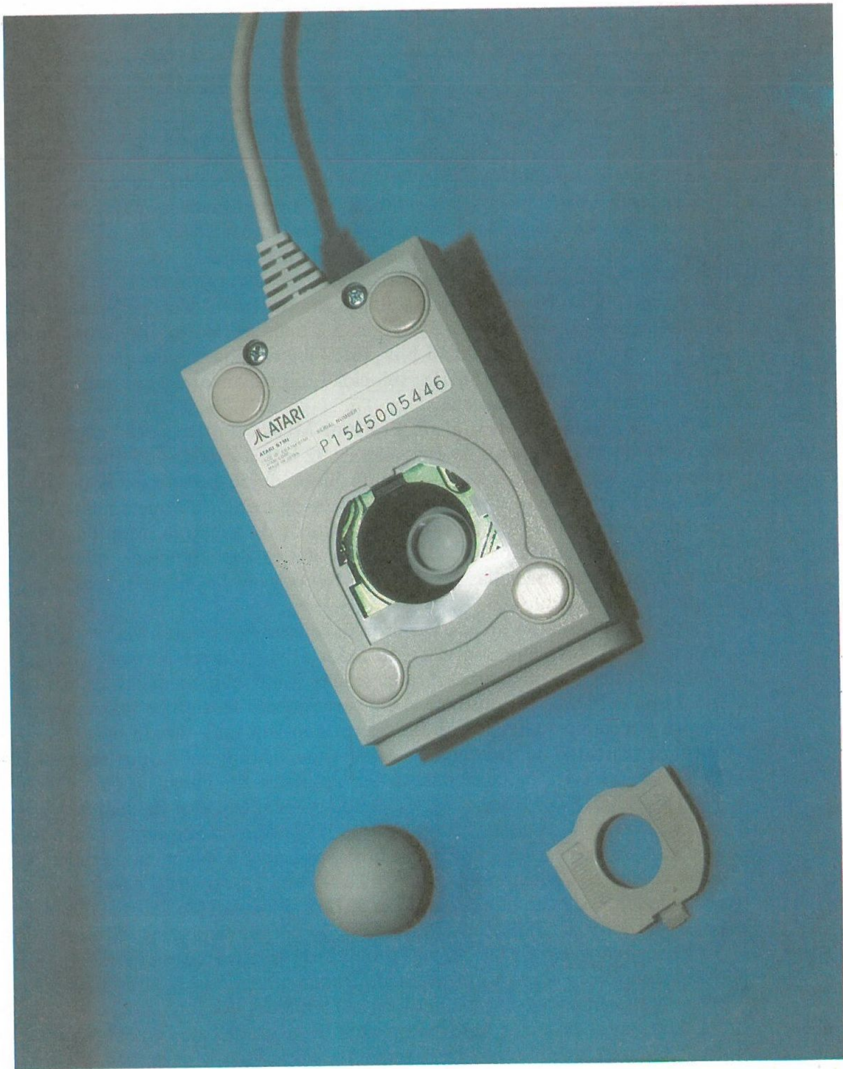
Mecanismo interno del ratón
