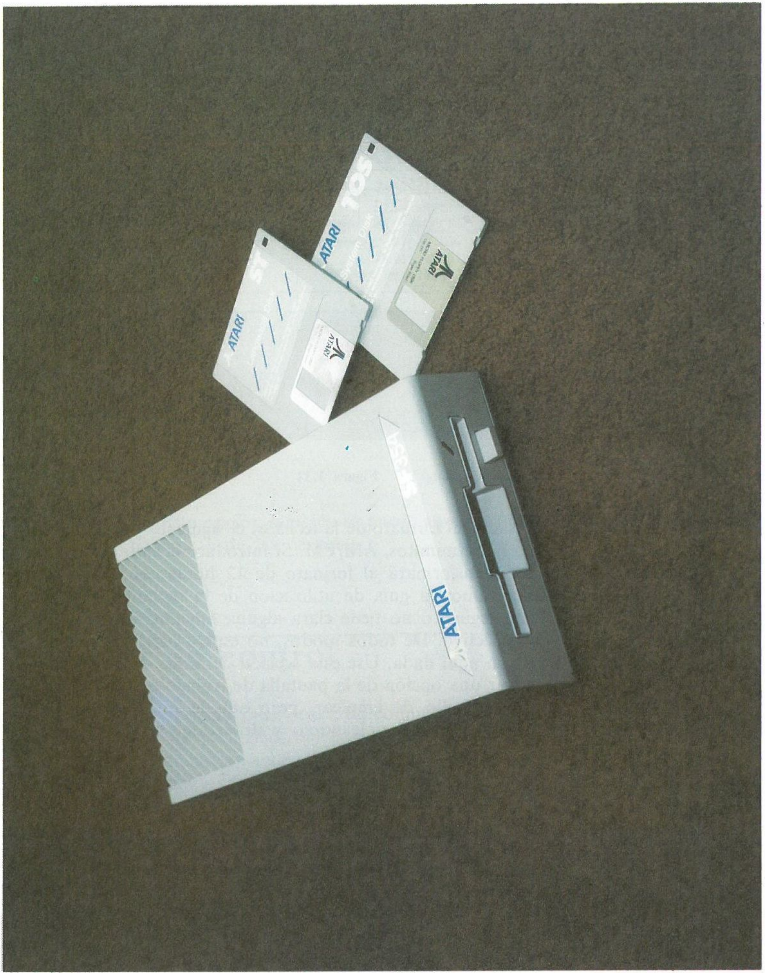
Unidad de disco (500K o 1M, sin formatear), discos del sistema de lenguaje que se suministra con la máquina
