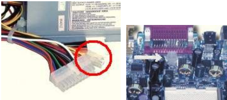
Conector ATX12V da fonte e o conector para ele na placa mãe
