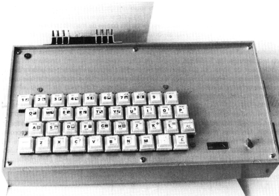
LE BOITIER ZX, MODIFIE AVEC CLAVIER MECANIQUE. Noter le galvanomètre indicateur de niveau et l'inverseur «LOAD-SAVE».
