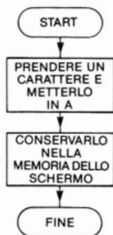
Figura 6.2 - Un diagramma di flusso per il programma "stampa un carattere"
