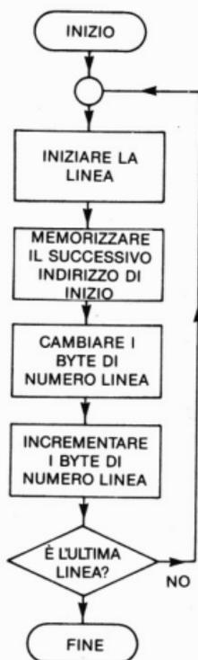
Figura 9.5 - Un diagramma di flusso per un programma di rinumerazione
