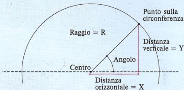
È possibile esprimere le distanze X e Y usando il valore del seno (SIN) e del coseno (COS) dell'angolo al centro. Ogni angolo ha i propri valori di seno e coseno; le coordinate di ogni punto della circonferenza sono date da:
