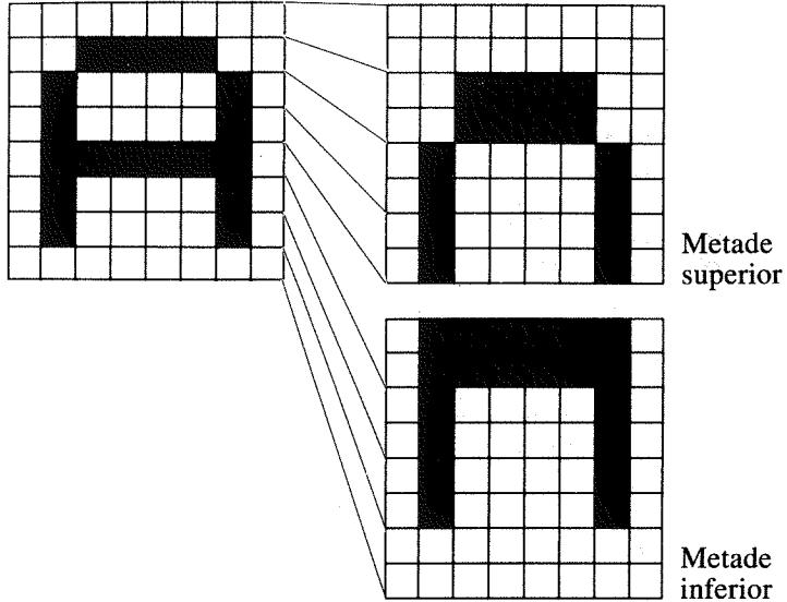
Assim, os quatro bytes superiores são duplicados de modo a obter os oito bytes superiores do novo carácter; os quatro bytes inferiores do original são do mesmo modo transformados nos oito bytes da metade inferior do novo carácter.
