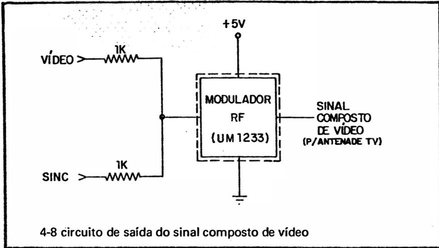
O modulador RF é uma caixa retangular blindada. Seu terra é a própria soldagem ao chassi. Os dois fios que entram nele correspondem ao sinal de vídeo (SINC + VÍDEO) e +5 Volts.
