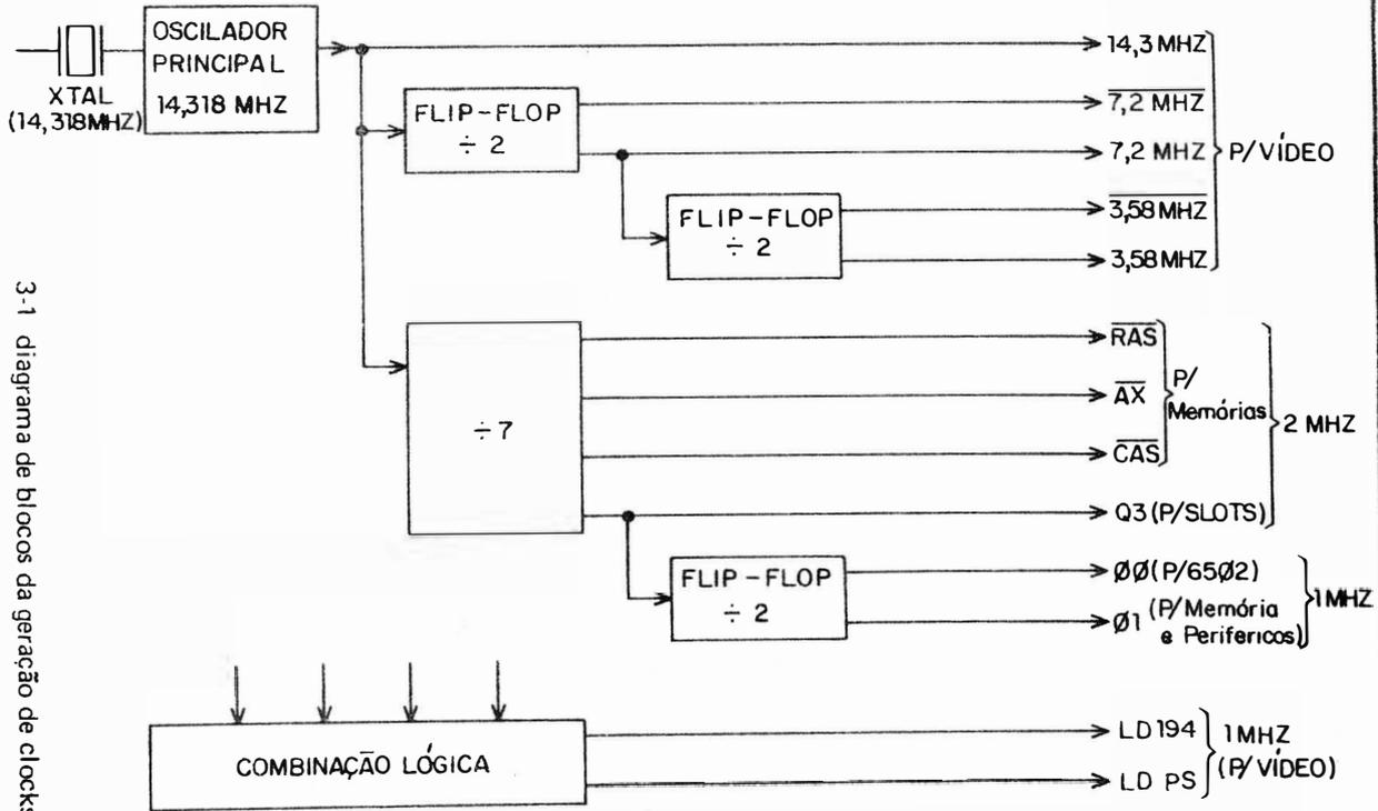
Na combinação lógica dos sinais anteriores retiramos LD194 e LDPS, ambos de 1 MHZ, usados no gerador de vídeo
