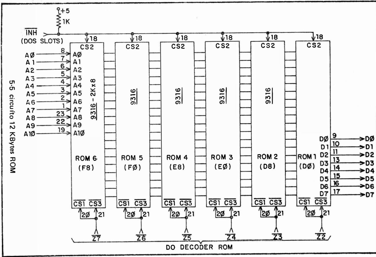
da fig. 5-2). Eles são conectados às entradas I2/I1/I0 do decoder, respectivamente. Os bits nas três entradas do decoder selecionam uma das saídas  $\overline{Z0}/\overline{Z7}$ , levando-a a nível L enquanto as outras permanecem em nível H, conforme a tabela da fig. 5-4. Deste modo se um endereço pertence a um dos 6 CIs ROM sua correspondente saída será levada a nível L, ativando-o enquanto os outros 5 CIs ROM permanecem desativados.
