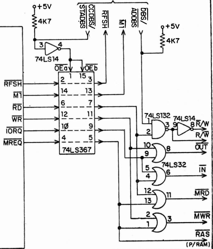
Com  $\overline{MREQ}$  e  $\overline{RD}$  em nível L a terceira OR levará a nível L sua saída  $\overline{MRD}$ , sinalizando leitura de memória. Finalmente se  $\overline{MREQ}$  e  $\overline{WR}$  estão em nível L será caracterizada a leitura de memória pelo nível L na saída  $\overline{MWR}$  da quarta OR.
