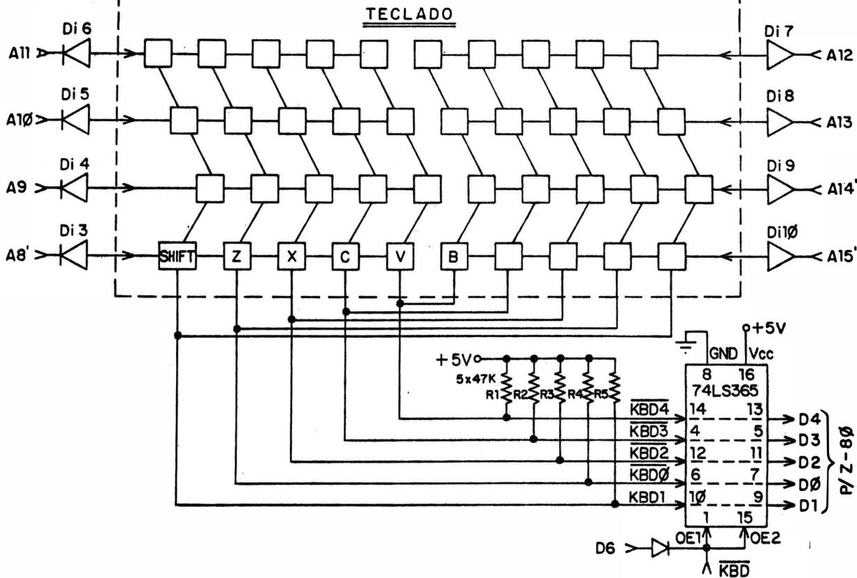
Note que as colunas são ligadas em pares. Por exemplo, a última coluna do lado esquerdo (onde se encontra 'V') está ligada à primeira coluna do lado direito (onde se encontra 'B'), ambas determinando o nível de KBD4 e D4. Na decodificação o Z-80 descobre se a tecla está na metade à esquerda ou à direita ao verificar qual terminal de endereço foi ativado em nível L (A18/A11 para o lado esquerdo e A12/A15 para o lado direito).
