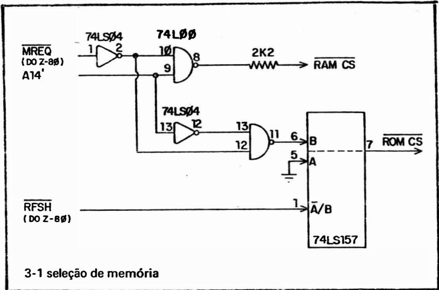
tem sua outra entrada (pino 12, recebendo  $\overline{\text{MREQ}}$  invertido) também em nível H, resultando na sua saída o sinal  $\overline{\text{ROM CS}}$  ativo em nível L. Isto é, durante a leitura de ROM o sinal  $\overline{\text{ROM CS}}$  está ativo em nível L e  $\overline{\text{RAMCS}}$  desativado em nível H.
