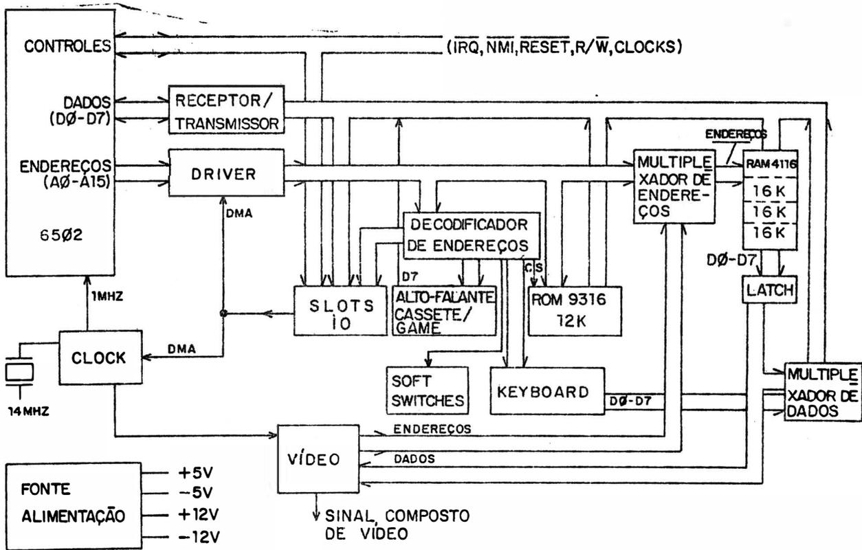
Na gravação (escrita - WRITE) da RAM os dados são recebidos diretamente da barra D0-D7. Na leitura (READ) os dados são enviados para um latch e atravessam um multiplexador, chegando finalmente à barra. Entretanto, quando há uma tecla pressionada, este multiplexador bloqueia a RAM e transmite à barra de dados os sinais D0-D7 recebidos do Keyboard, correspondente ao código ASCII da tecla.
