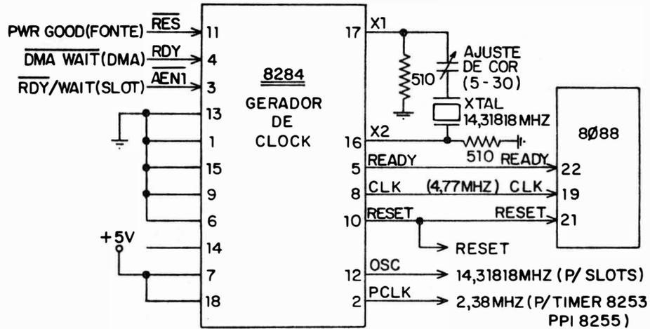
A frequência de clock dividida por 2 (ou seja, a frequência do oscilador dividida por 6) origina o sinal de 2,38MHZ disponível para o timer (CI 8253) e sincronização de periféricos (CI8255).
