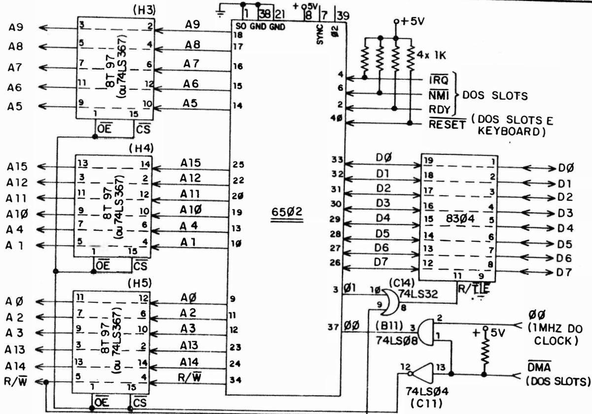
Observe que a DMA só pode ser solicitada por periférico nos slots. Os periféricos embutidos ("on board") não têm acesso a essa função. O terminal RDY (pino 2) não participa de operações DMA.
