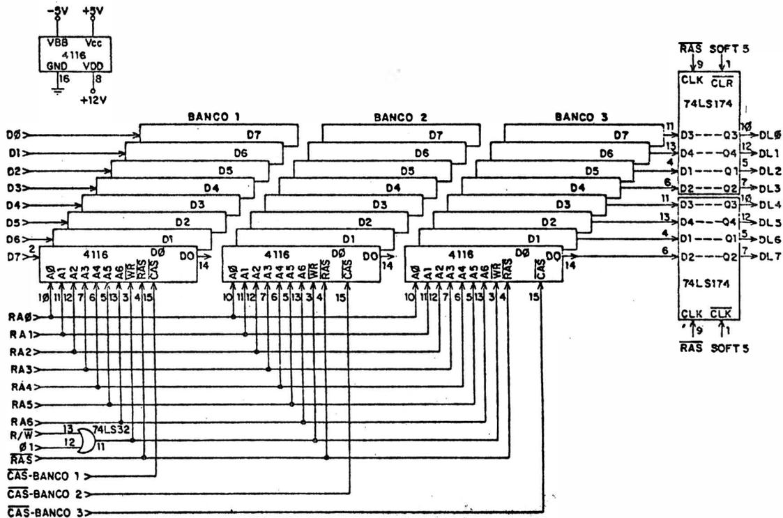
frescamento) periódico para conservar o dado armazenado. O processo de refresh é realizado automaticamente pelos circuitos internos do CI quando ele executa uma operação de leitura (write em nível H), com a devida ativação de RAS. No APPLE II ocorre uma leitura de RAM a cada fase  $\phi_1$  (vídeo), levando WRITE a nível H e ativando RAS dos três bancos, garantindo o refresh em intervalos de tempo adequados.
