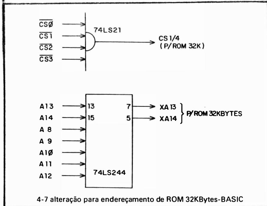
Entretanto, o CI DE 32Kbytes fica na posição 960K a 992K, ocupando o espaço de quatro CIs de 8 Kbytes. Por isso deve ser habilitada por qualquer um dos sinais de seleção  $\overline{CSX}$  correspondentes aos quatro CIs de 8KBytes. Uma maneira simples é combinar  $\overline{CS0}$  -  $\overline{CS1}$  -  $\overline{CS2}$  -  $\overline{CS3}$  numa AND 74LS21 (fig. 4-7).
