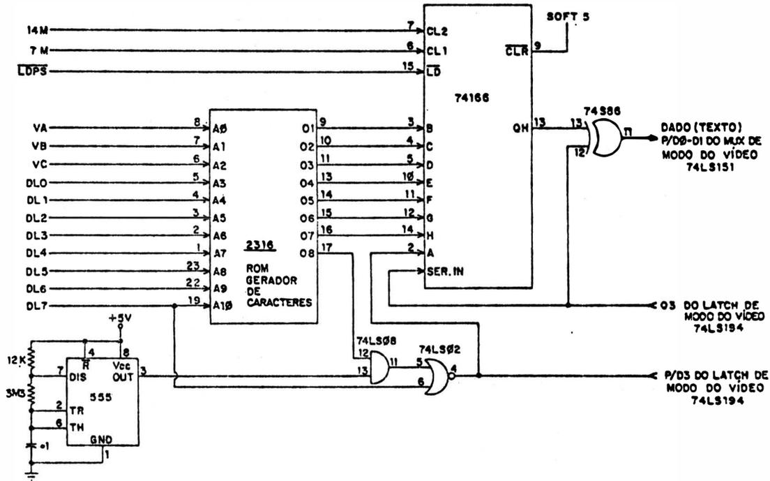
bits em apenas um ciclo de  $\overline{\text{LDPS}}$ . A saída serial é feita pelo pino 13-QH e é enviada aos pinos D0-D1 do multiplexador de modo, podendo ser invertida ou não (vídeo inverso) na porta EOR 74S86, dependendo da programação do dado DL7 recebido da RAM.
