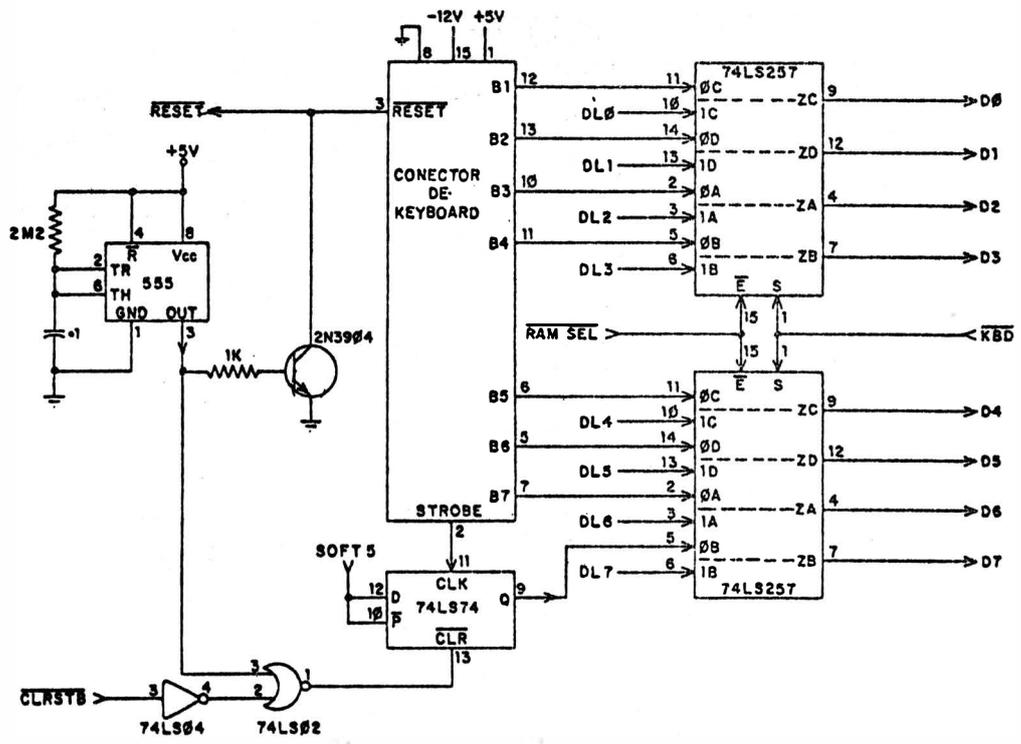
Logo após o micro ser ligado o timer 555 emite pulso positivo com o mesmo efeito da ativação de CLR STB na NOR 74SL02, além de levar o transistor Q5 à saturação (coletor em 0,2 Volts), o que provoca o pulso negativo RESET para o 6502. A ativação de RESET também ocorre quando é ativada esta tecla no Keyboard (fig. 6-14).
