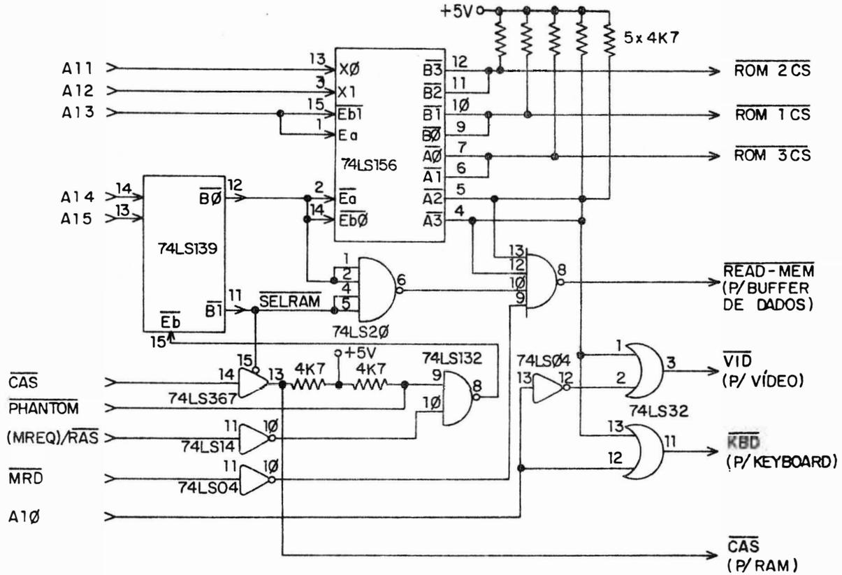
aqui; a outra metade - decoder 'a' - não faz parte do circuito) cujas saídas  $\overline{B0}$  e  $\overline{B1}$  dependem das entradas 0b e 1b, que recebem os terminais de endereço A15 e A14.
