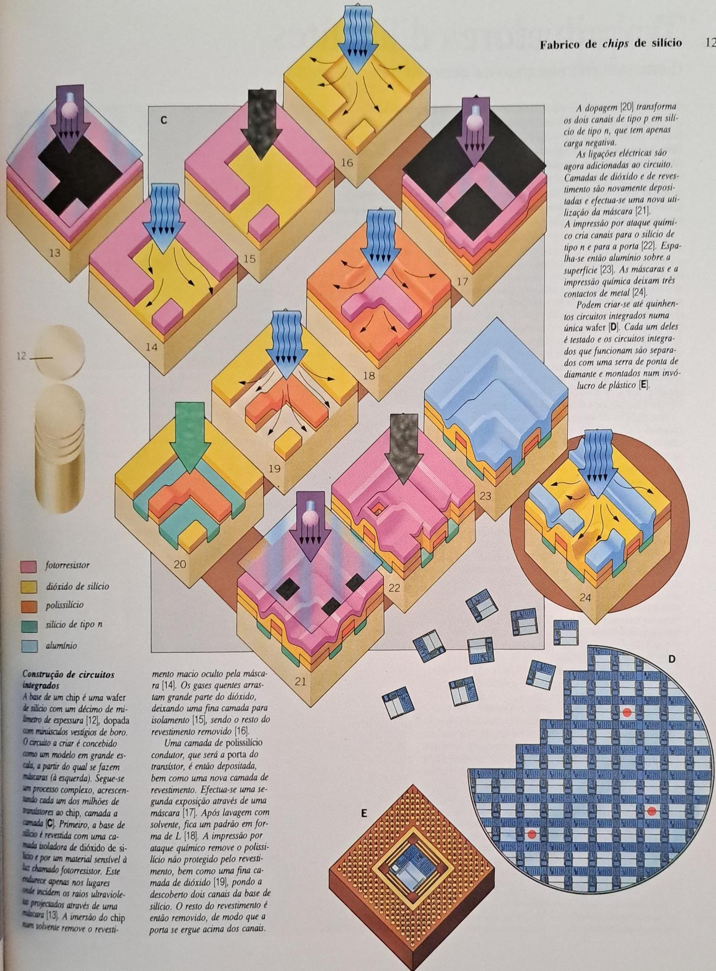
A dopagem [20] transforma os dois canais de tipo p em silício de tipo n, que tem apenas carga negativa.
