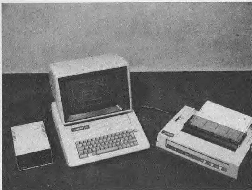
ROM, un teclado completo formado por 63 teclas con posibilidad de generar letras mayúsculas y minúsculas (diferencia apreciable con respecto al anterior II Plus), siete ranuras de expansión para E/S con los periféricos más variados y un monitor de 24 líneas por 40 columnas o con la tarjeta adecuada, muy reducida en tamaño y coste, 80 columnas.
