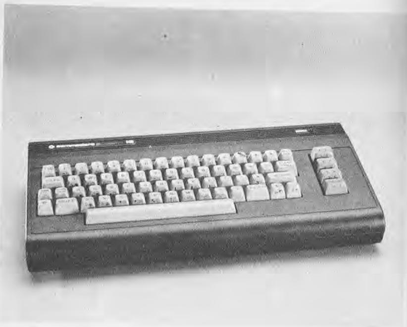
Pero quizá la diferencia más notable reside en las teclas que controlan el movimiento del cursor: no es necesario recurrir ya, para dos de las direcciones, a la presión simultánea de la tecla Shift; se trata de cuatro teclas efectivas y diferentes que ocupan posiciones inmediatas a la izquierda de la tecla Ctr/Home. También los diferentes códigos de los caracteres son los estándares del sistema Commodore.
