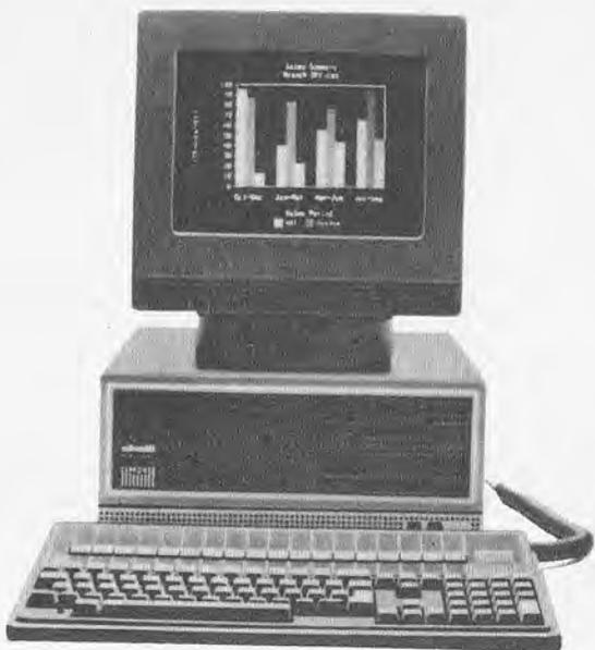
sador numérico 8087, previsto como opción. La RAM parte de 128 Kbytes ampliables hasta 640. En la configuración básica está incorporada una unidad de disquetes de 5"1/4 de tipo plano con capacidad de 360 Kbytes/720 Kbytes. Admite una segunda unidad.
