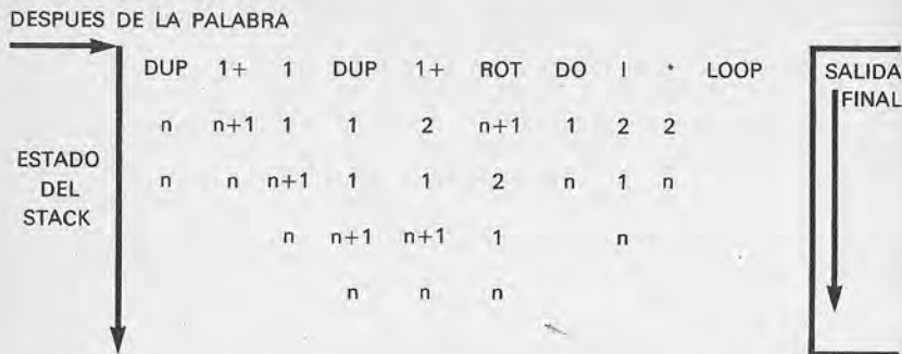
Figura 8.—Análisis del stack durante la ejecución de la palabra "!!". n=Número cuyo factorial se quiere calcular.
