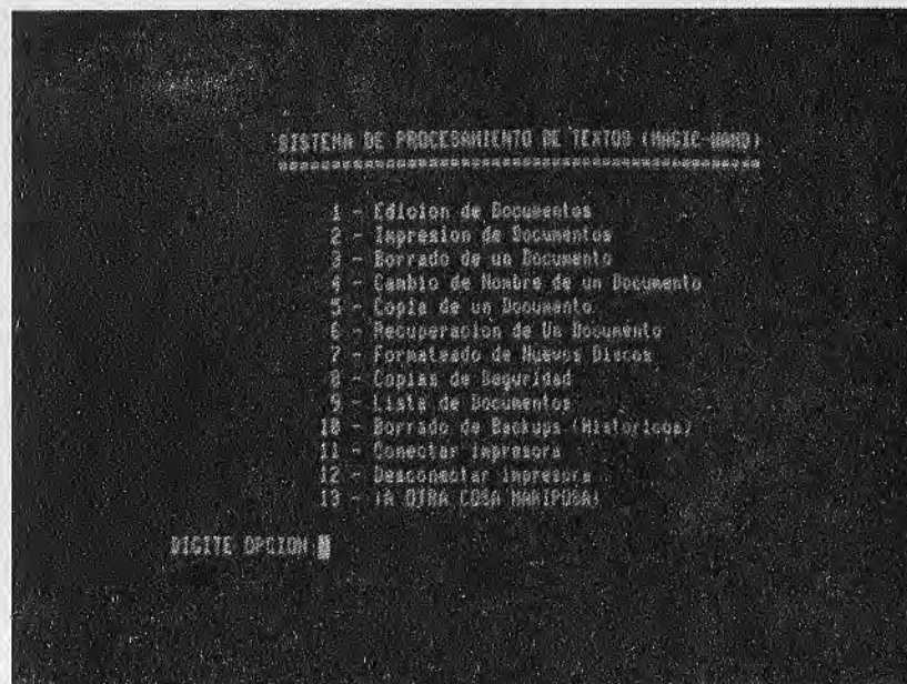
Figura 3.—Pantalla correspondiente al menú principal del Magic-Wand. Se pueden variar el número y tipo de opciones cambiando un subprograma, accesible al usuario, y empleando los comandos adecuados del sistema operativo Oasis, que es el que usa.
