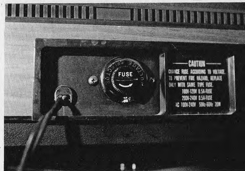
Figura 5.— Fuente de alimentación con fusible y selector de tensión.
