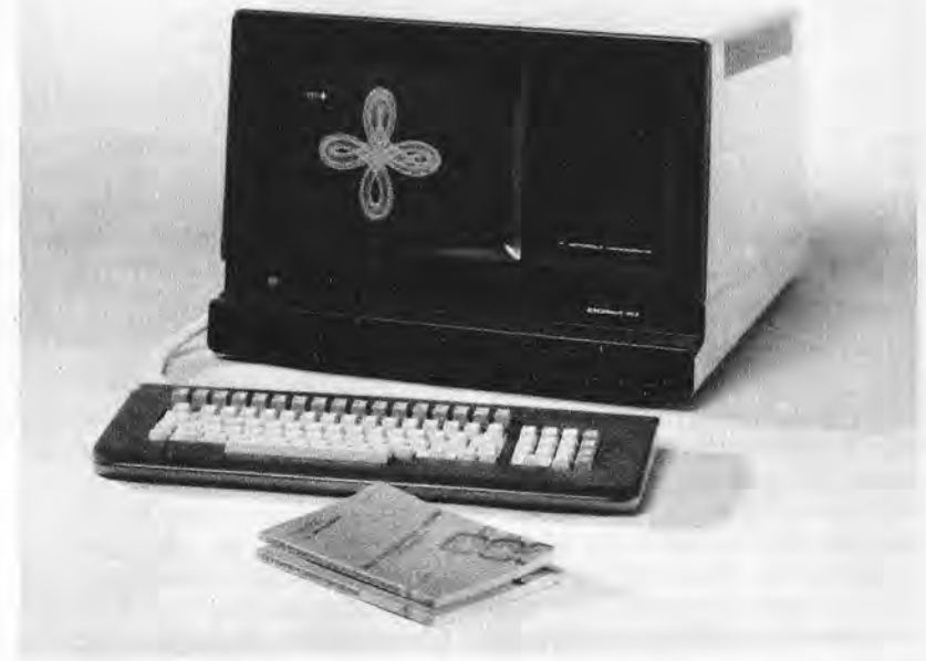
Fig. 5. Sistema en tiempo real EXORset-163 de Motorola dedicado a aplicaciones en tiempo real y a operaciones multitarea.
