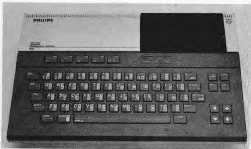
Fig. 7. A la derecha del teclado de este ordenador MSX están situadas las teclas de control del cursor, dispuestas en forma de estrella.
