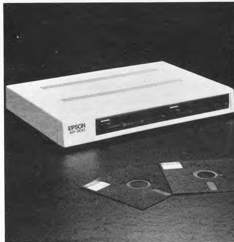
Fig. 15. Unidad de disco doble, ultraplana, concebida para el ordenador Apple II.
