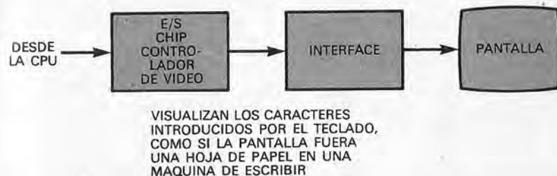
Fig. 5 - Conexión de la pantalla, manejada por un chip controlador de vídeo especial que, ante la CPU, aparece como un port de salida normal.
