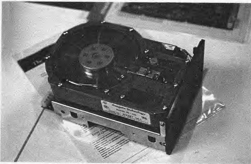
Foto 4 - Unidad de disco rígido en la que puede verse el disco al haber quitado la tapa.
