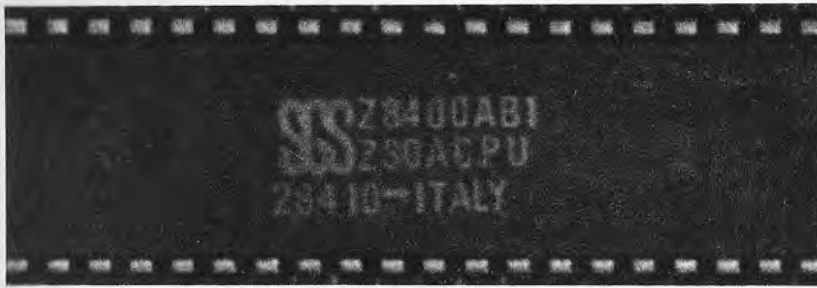
Fig. 6 - Fotografía del chip de silicio que constituye el microprocesador Z80.
