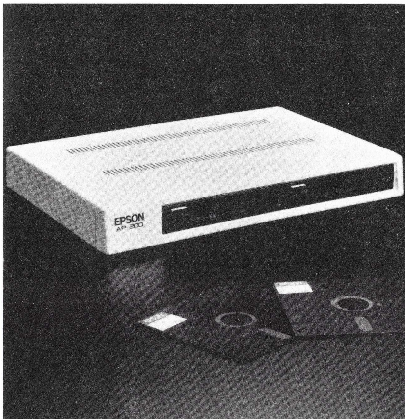
Fig. 15. Unidade de disco dupla, ultraplana, concebida para o computador Apple II.
