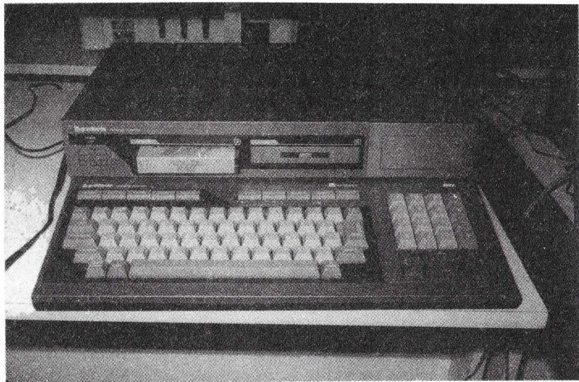
Fig. 7. À direita do teclado deste microcomputador MSX estão situadas as teclas de controle do cursor, dispostas em forma de cruz.
