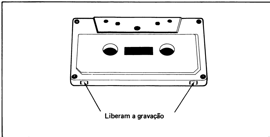
FIGURA 2.2. Dispositivos de Proteção em Fitas Cassete.
