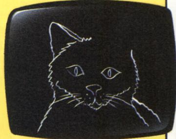
Según el brazo traza la figura del gato, los ángulos de sus juntas van cambiando. Dentro de las juntas hay potenciómetros que miden los ángulos y mandan diferentes voltajes a la computadora según sean los ángulos. El programa que viene con el tablero convierte estas lecturas del voltaje en diferentes posiciones de la pantalla.
