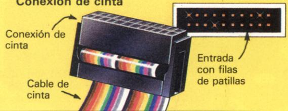
Una conexión de cinta contiene una funda de plástico con filas de agujeros. Estos coinciden con filas de patillas en la entrada. El cable es plano y se conoce como cable de cinta. Está formado de multitud de cables juntos. El cable de cinta lleva señales paralelas como pueden ser las necesarias para una impresora al conectarse a un interfaz de paralelo centronics (Ver páginas 6-7).
