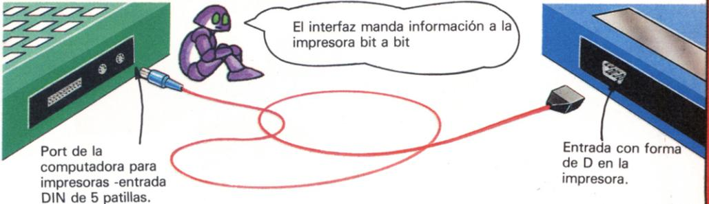
El interfaz estándar para impresoras en serie se conoce como RS232 o V24. Las entradas de la computadora y de la impresora suelen ser como éstas. Algunos interfaces RS232 necesitan un convertidor extra para funcionar con impresoras en serie. El VIC 20 y el
