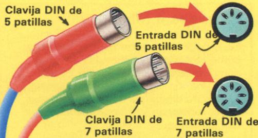
Una clavija DIN posee varias patillas diminutas; normalmente cinco o siete; rodeadas por un aro de metal. Las patillas tienen funciones diferentes por lo que van conectadas a diferentes filamentos del cable. Muchos cables para la grabadora tienen clavijas DIN en el extremo.
