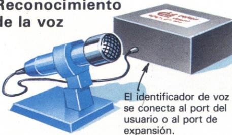
Puedes programar tu micro para que reconozca ciertas palabras habladas usando un sistema de identificación de voz. Este suele ser un aparato conectable que viene con un micrófono y con software. Puedes usar el sistema, por ejemplo, para dar instrucciones a un robot controlado por la computadora o para juegos.
