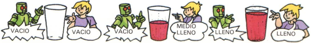
El dibujo superior muestra la diferencia entre las señales digitales y analógicas. Una señal digital sólo puede estar activa o inactiva por lo que el vaso está lleno o vacío. La señal
