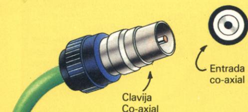
La clavija co-axial contiene una patilla en el centro de un arco de metal. Hay dos filamentos en el cable; uno conectado a la patilla y el otro al aro. Se usan, por ejemplo, para conectar la computadora a un aparato de TV o a un monitor.
