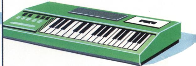
Algunos sintetizadores electrónicos con teclado pueden conectarse a una micro. Puedes almacenar una secuencia de notas compuestas con el teclado y distorsionarlas o manipularlas con el software.
