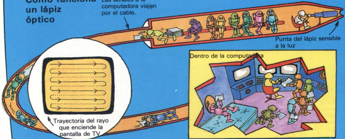
La imagen en la pantalla de TV se forma por un rayo de luz que recorre la parte trasera de la pantalla iluminándola. La punta del lápiz óptico es sensible a la luz. Cuando el rayo coincide con la punta el lápiz manda una señal a la computadora.
