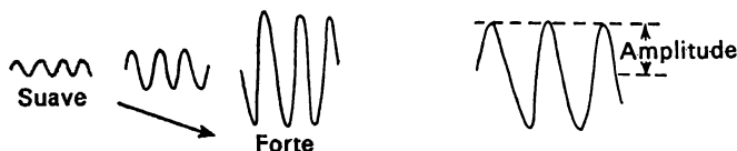
Fig. 1.4.— A amplitude de uma onda é uma medida que os nossos ouvidos reconhecem sob a forma de intensidade do som.
